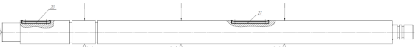
Рисунок 1.8 – Схема базування на операцію 050
