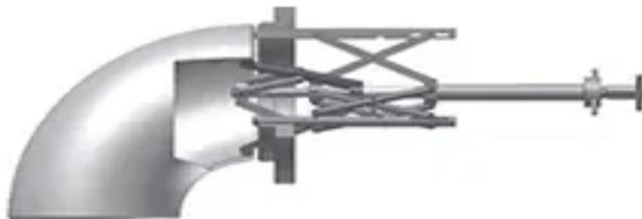
Рисунок 2.6 – Центратори серії ІМФ для приварювання фланців
