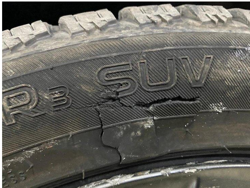
Рисунок 3.3. Тріщини на боковині
