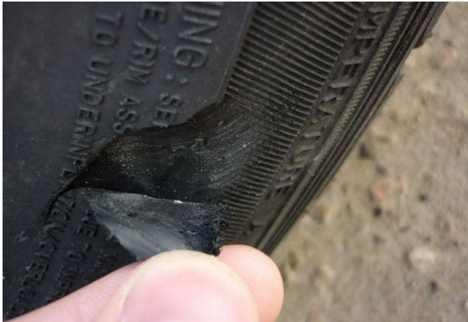
Рисунок 3.6. Розшарування протекторної стрічки
