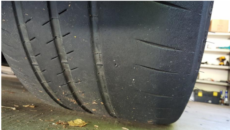
Рисунок 3.4. Асиметричний знос протектора
