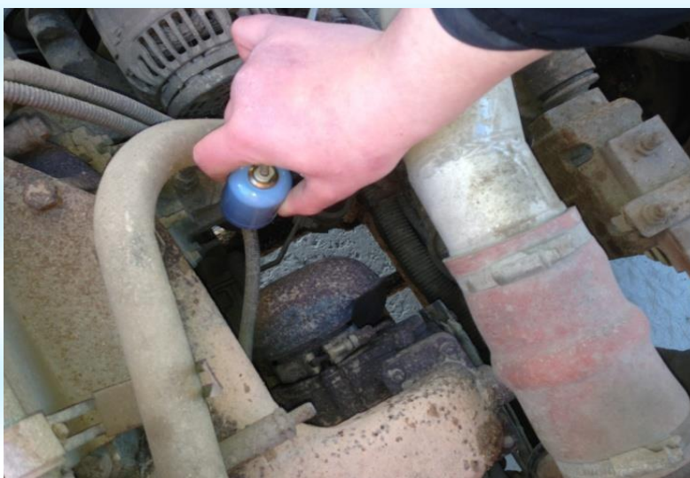
Вимірювання калібратором тиску "Метран" розрідження ти тиску палива в паливопроводі системи Common Rail
