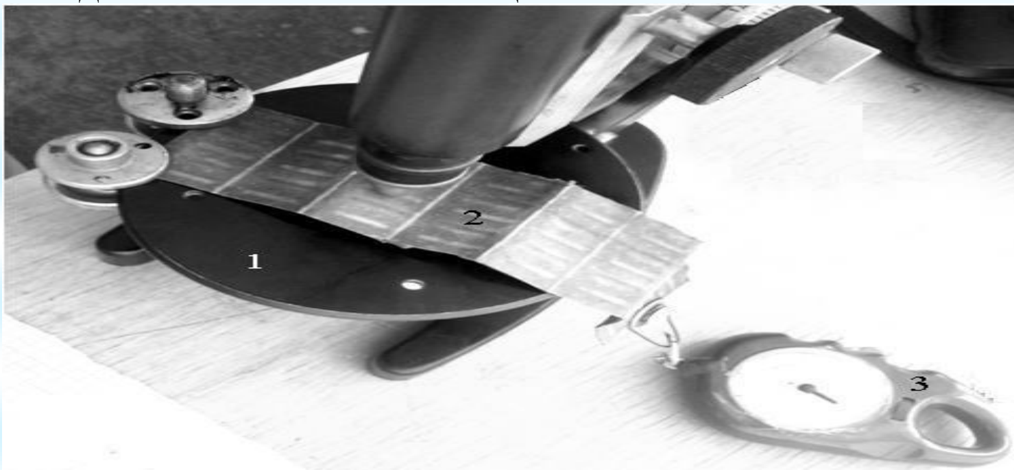
1 - мікроскоп; 2 - мембрана фільтра, закріплена на столі мікроскопа; 3 – динамометр
