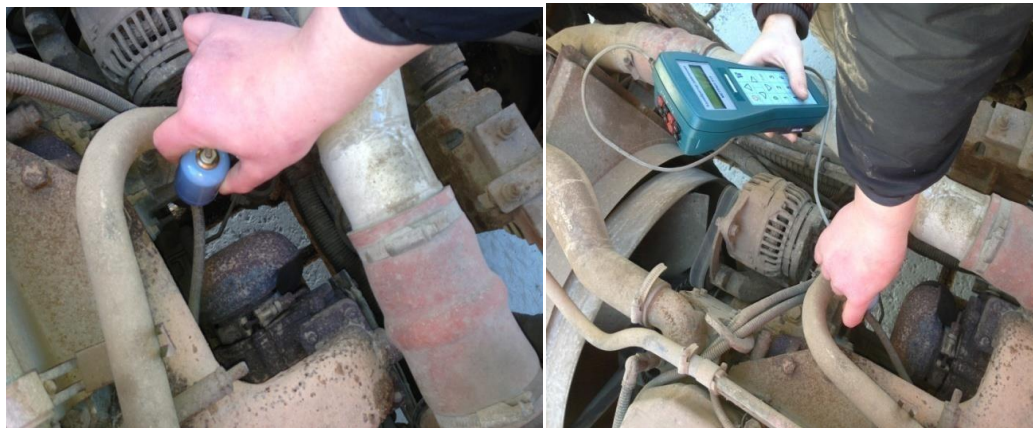
Рисунок 3.14 – Вимірювання калібратором тиску "Метран" розрідження в паливопроводі системи Common Rail
