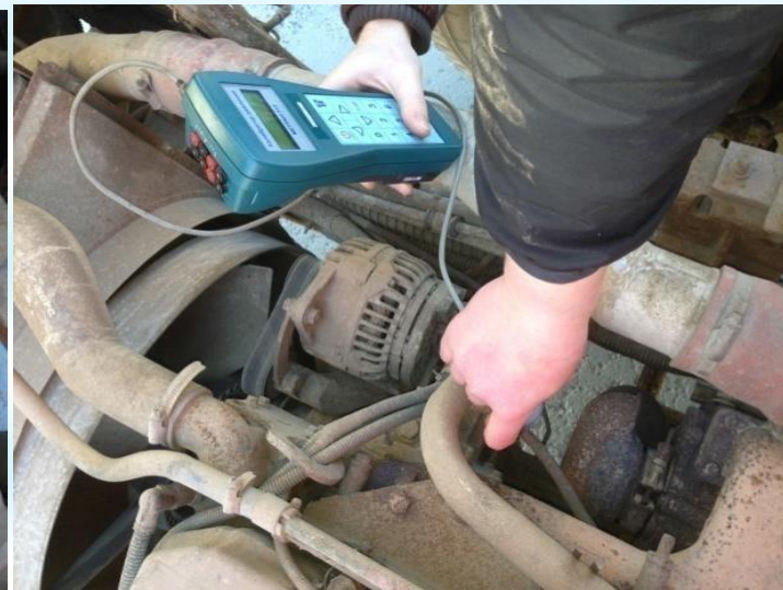
Вимірювання калібратором тиску "Метран" розрідження ти тиску палива в паливопроводі системи Common Rail
