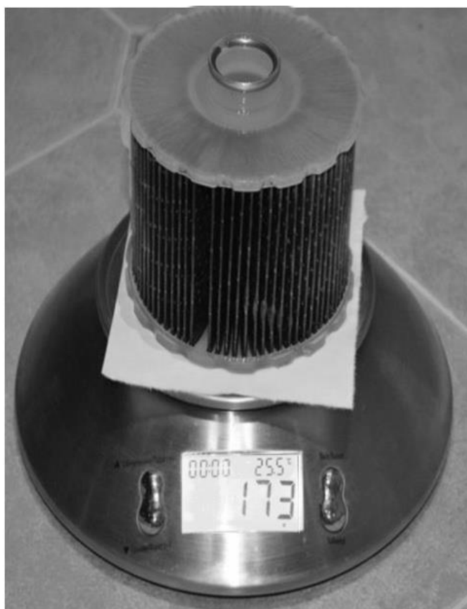
Рисунок 3.12 - Вимірювання маси фільтра з пробігом 20 000 км
