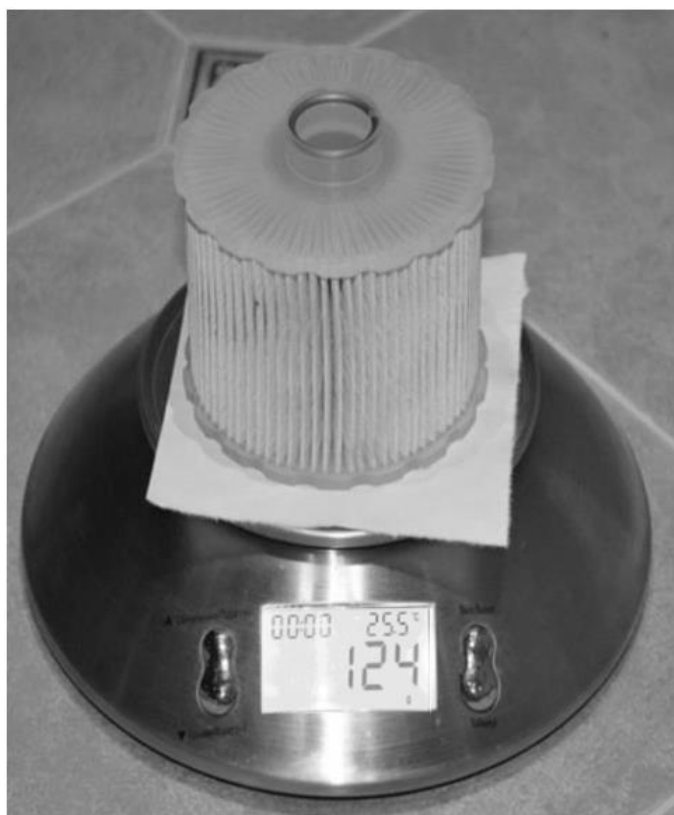
Рисунок 3.10 - Вимірювання маси нового фільтра після заповнення паливом і подальшої просушки
