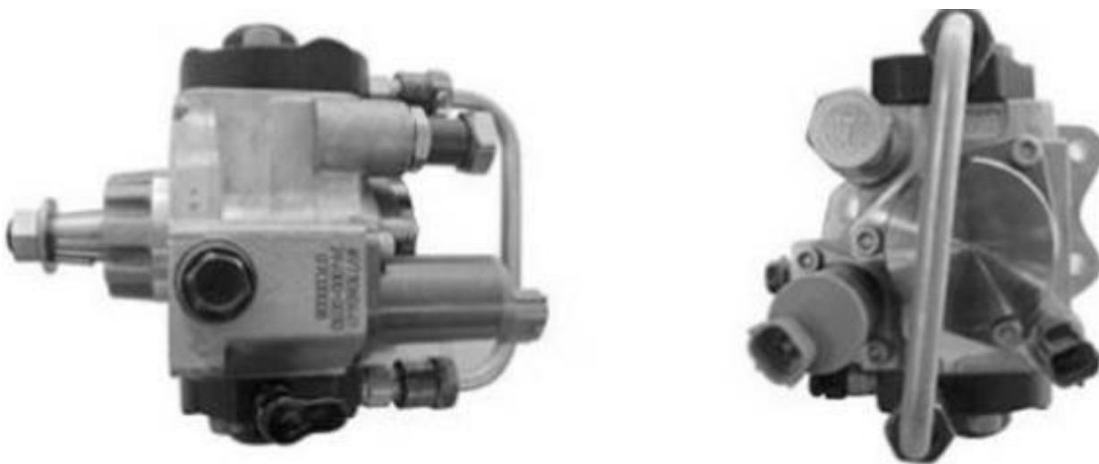
Рисунок 3.8 – Паливопідкачуючий насос Feed pump
