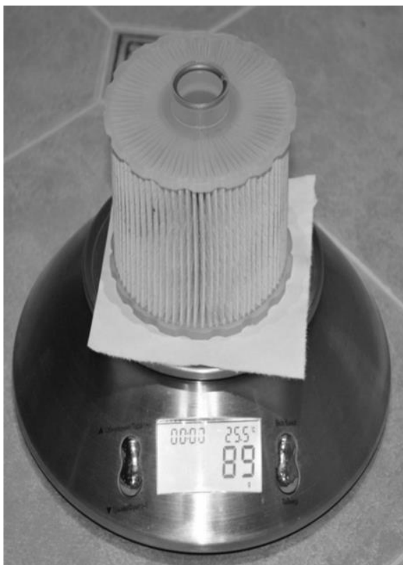
Рисунок 3.9 – Вимірювання маси нового фільтра
