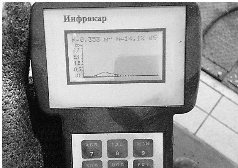
Рисунок 3.21 – Вимірювання димності. Вимір №5
