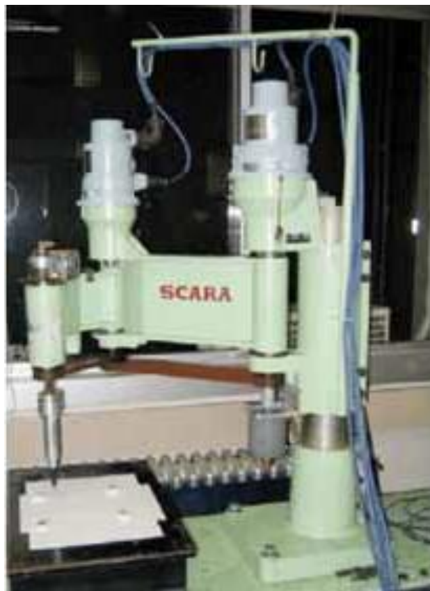
Рис. 1.1. – Перший робот SCARA
