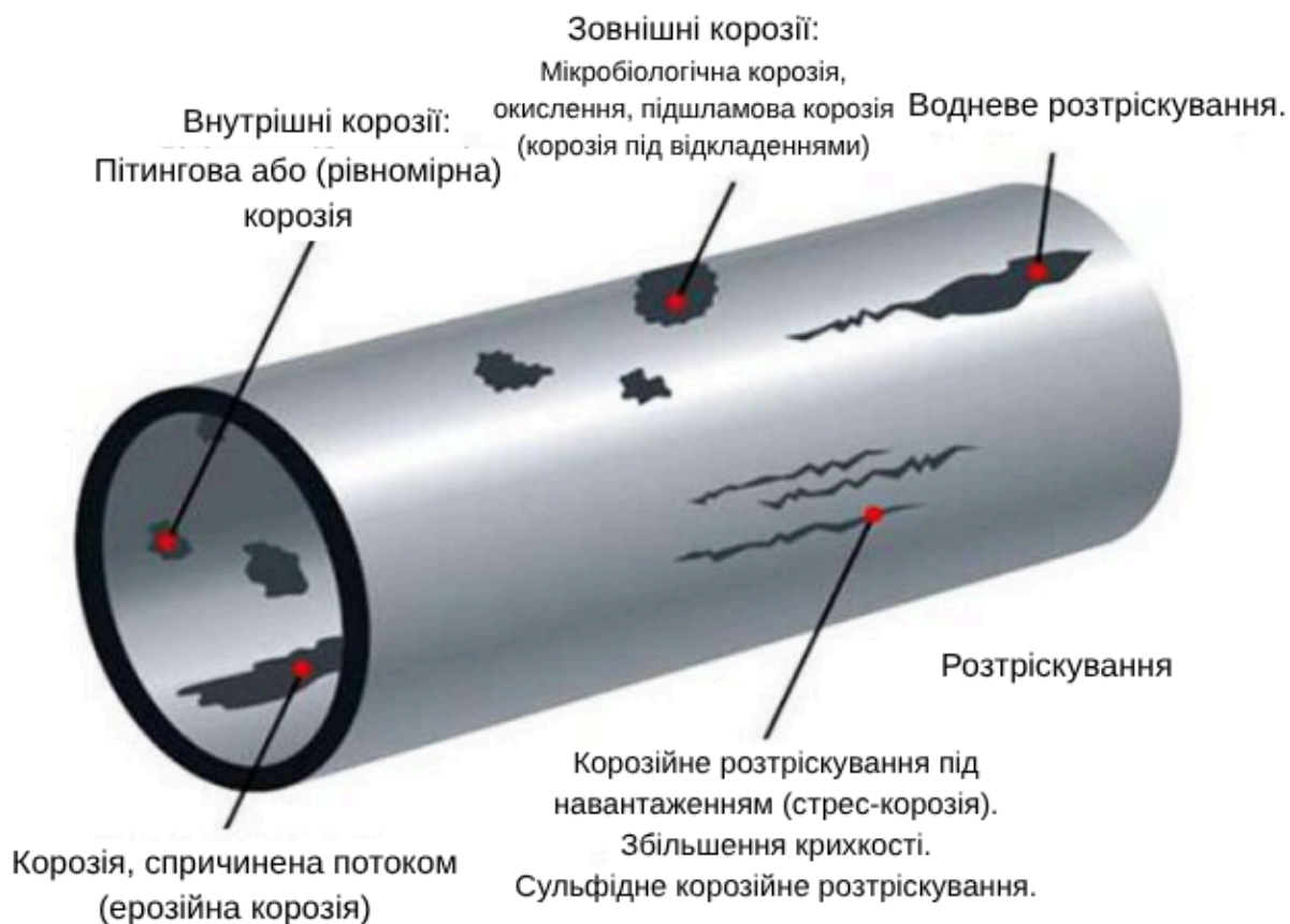
Рисунок 1.2 - Основні пошкодження трубопроводу за місцем виникнення та механізмом руйнування
