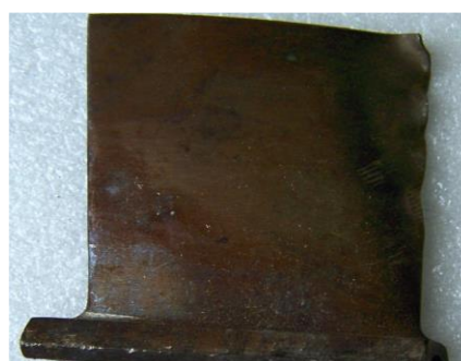
Рисунок 1.5 – Деформація вхідної кромки профілю лопатки компресора
