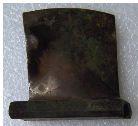
Рисунок 1.3 – Пошкодження лопатки компресора із розвитком тріщини
