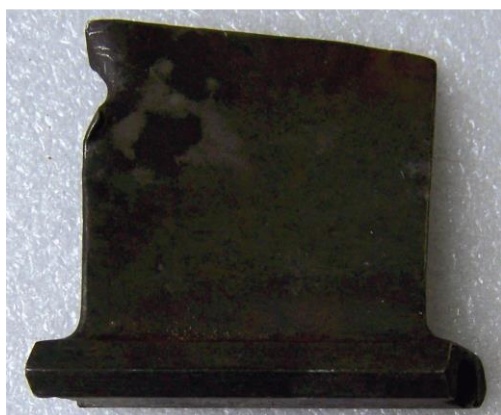
Рисунок 1.2 – Лопатка компресора з механічним пошкодженням кромки
