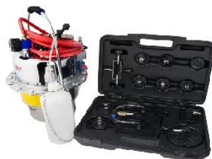
Рисунок 3.8 - Пристрій Forsage F-9T3608U для заміни гальмівної рідини
