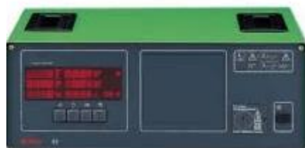
Рисунок 3.3 - Автомобільний 4-ьох компонентний газоаналізатор BOSCH ETT 8.55
