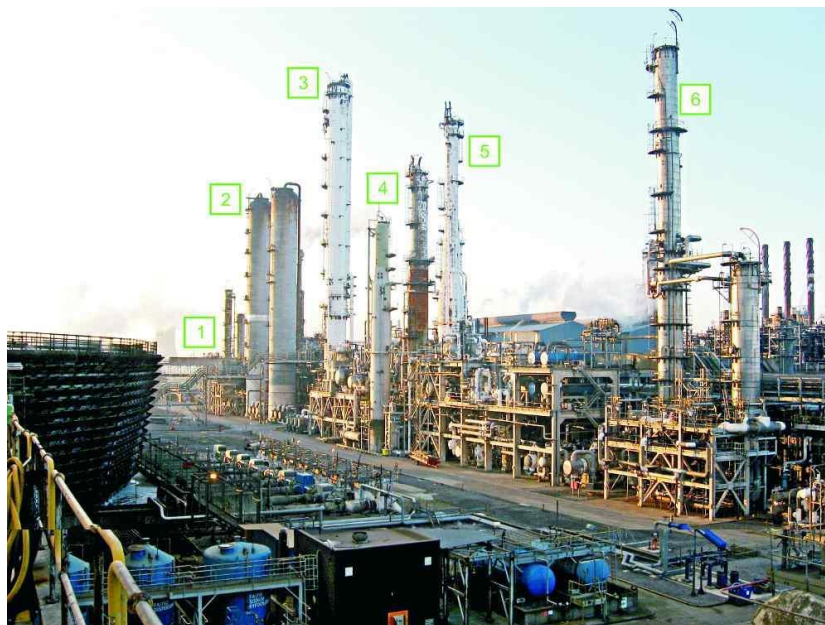
Рис. 1.5. Продукти парового крекінгу включають суміш вуглеводнів C1-C4 і розділяються шляхом фракційної перегонки. Деякі колони: 1 - Дебутанізатор, який відокремлює вуглеводні C4 від вуглеводнів C1 - C3; 2 - Депропанізатор, який відокремлює вуглеводні C3; 3 - Деетанізатор, який відокремлює вуглеводні C2; 4 - Деметанізатор, який відокремлює метан; 5 - Розділювач C3 який відокремлює пропен від пропану; 6 - Розділювач C2, який відокремлює етен від етану
