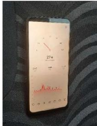
Рисунок 3.7 - Робоче вікно мобільного додатку Sound Meter та розташування телефону під час вимірювання (фотографії автора)
