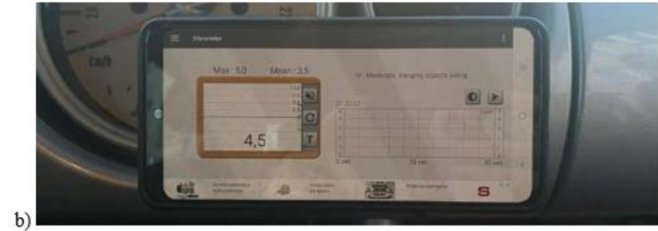
Рисунок 30 - а) Робоче вікно мобільного застосунку Vibrometer; б) Місце кріплення телефону в автомобілі
