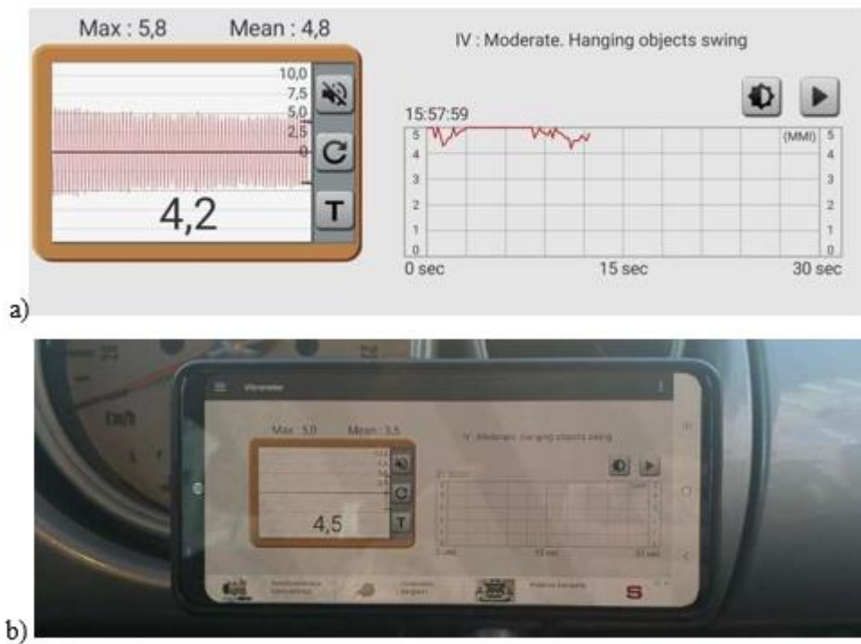
Рисунок 3.10 а) Робоче вікно мобільного застосунку Vibrometer; б) Місце кріплення телефону в автомобілі (фотографії автора)
