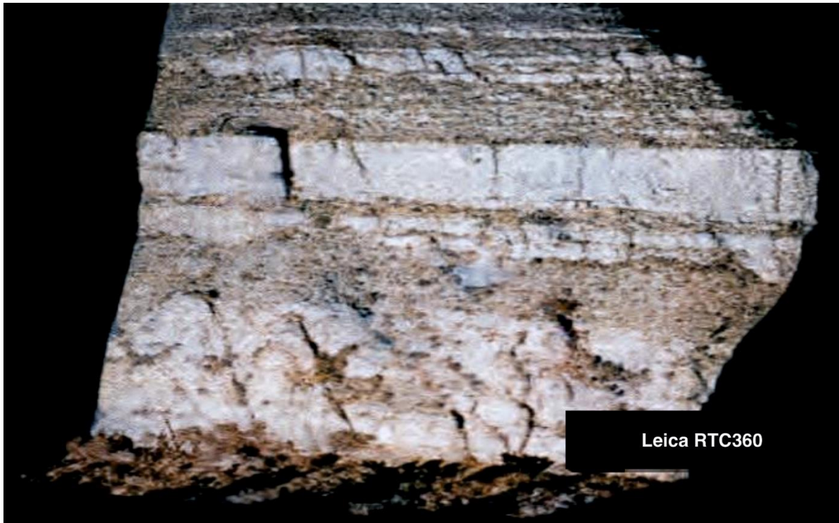
Рисунок 6. Цифрове тривимірне відображення хмар над стрімкими скелями, створене з використанням лазерного сканера Leica.
