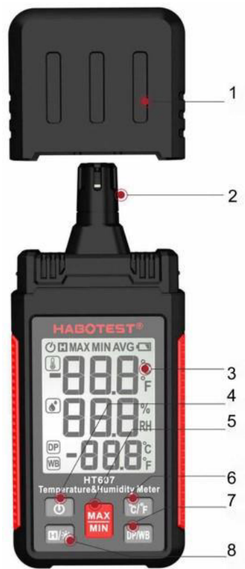
Рисунок 2.9 – Будова гігрометра точки роси NaboTest HT-607
