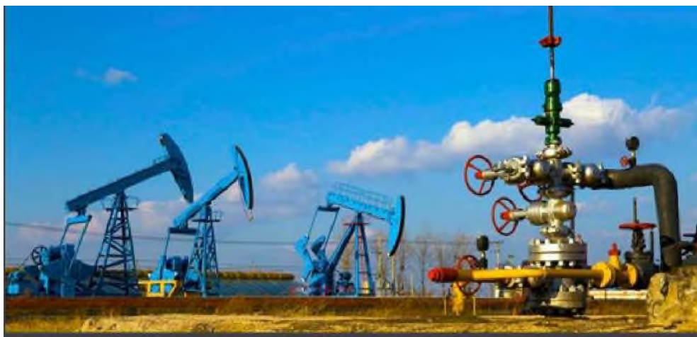
Рисунок 1.3 – Обладнання устя для подачі хімічних реагентів в свердловину Особливості конструкції обладнання устя для подачі хімічних реагентів значною мірою залежать від умов експлуатації конкретної свердловини.
