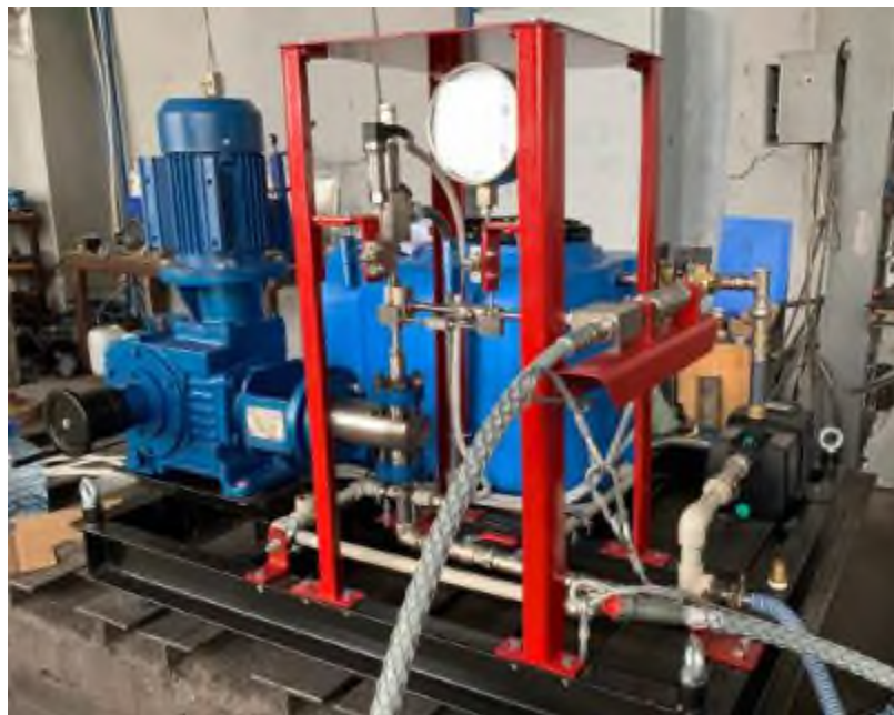
Рисунок 1.8 – Установа насосна блокова УНБ виробництва Харківського насосного заводу [8]
