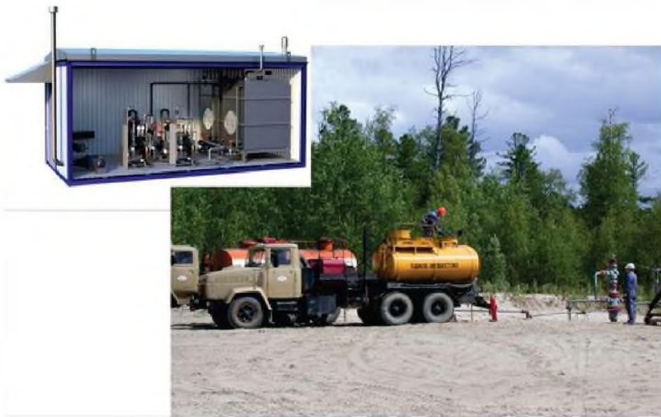
Рисунок 1.2 – Пересувні установки для подачі інгібітора Обладнання устя свердловини, яке застосовують для подачі в свердловину хімічних реагентів показане на рисунку 1.3.
