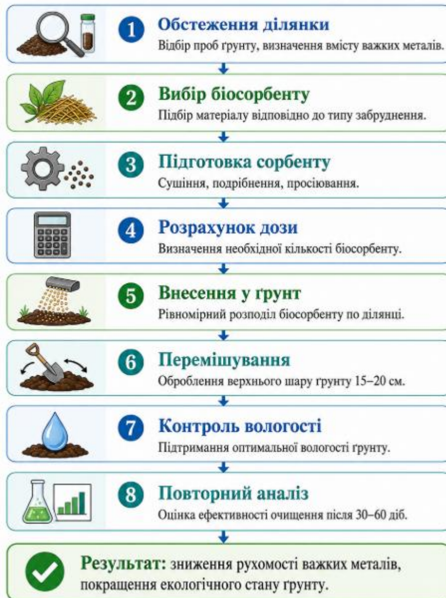
Рисунок 4.1 Технологічна схема застосування рослинних біосорбентів для очищення забрудненого ґрунту.
