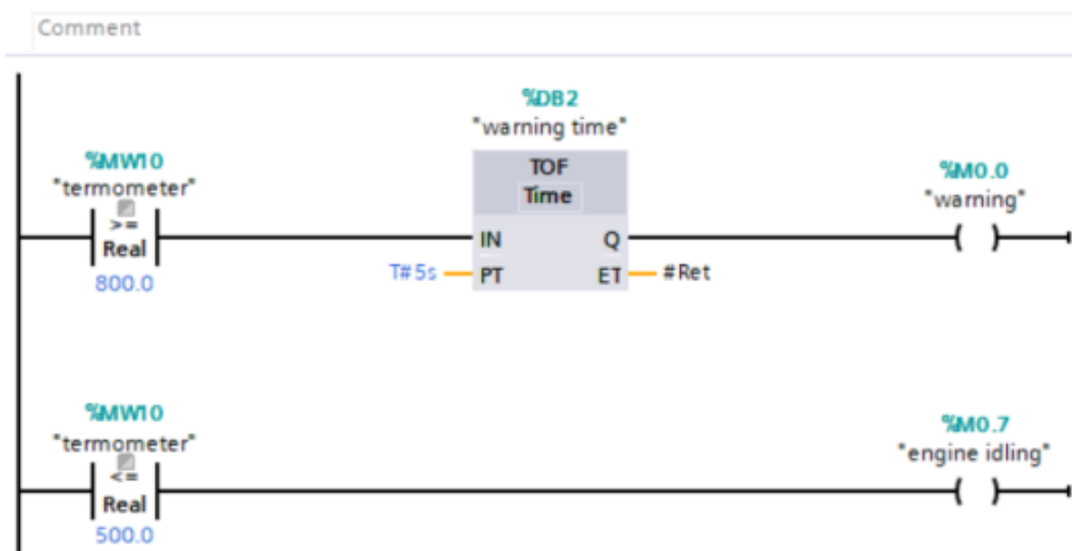
Рис. 5.7. Логіка функціонування системи аварійної зупинки та індикації холостого режиму
