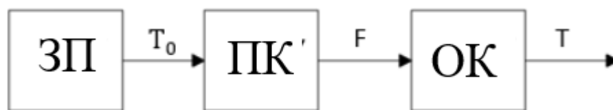
Рис. 4.2. Функціональна схема контуру програмного керування температурою в камері згоряння
