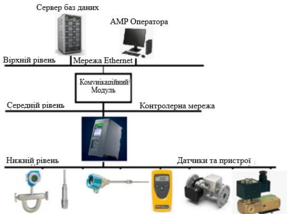
Рис. 2.1. Рівні САР газотурбінним двигуном
