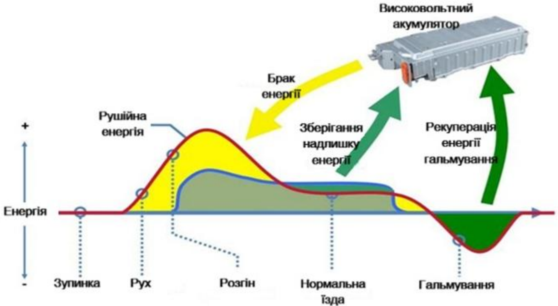
Рисунок 1 – Діаграма витрати енергії гібридним автомобілем [1]
