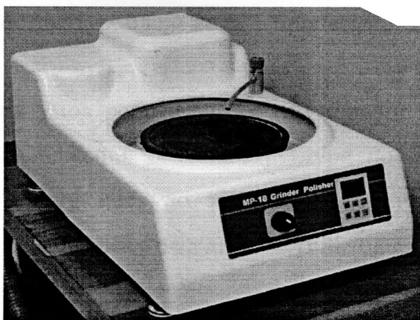
Рисунок 3.7 – Загальний вигляд пристрою для шліфування і полірування металографічних зразків УШПО – 1
