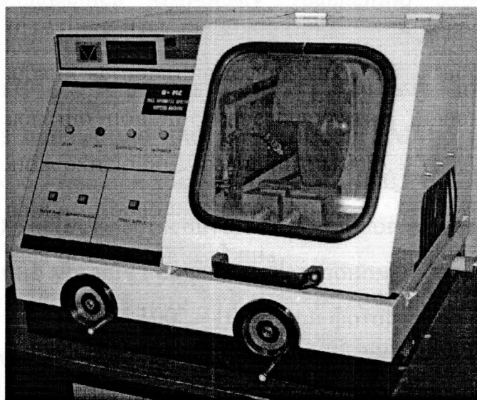
Рисунок 3.6 – Загальний вигляд верстата для вирізування металографічних зразків УРМО – 80А
