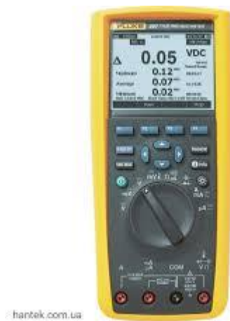
Рисунок 3.3 – Еталонний цифровий мультиметр високої точності для калібрування каналу напруги комірок [7]
