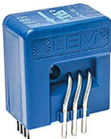
Рисунок 2.4 – Датчик струму на ефекті Холла компенсаційного типу для систем оперативного захисту [16]
