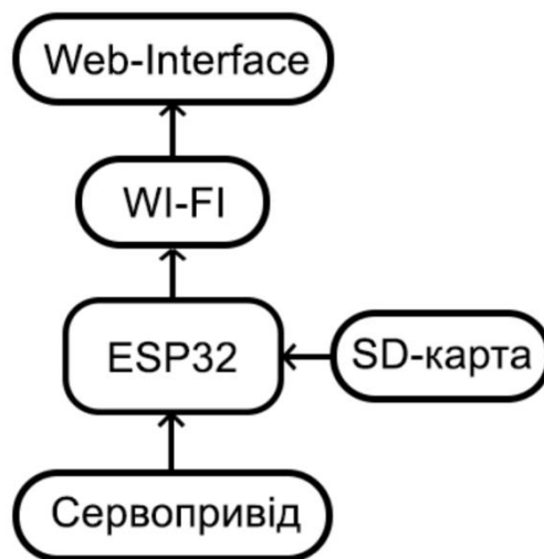
Рисунок 2.1 – Структурна схема системи управління бар’ером на ESP32
