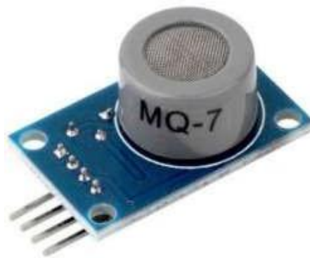
Рисунок 2.7 – Датчик чадного газу MQ-7
