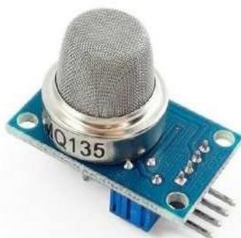
Рисунок 2.5 – Модуль сенсора якості повітря MQ-135
