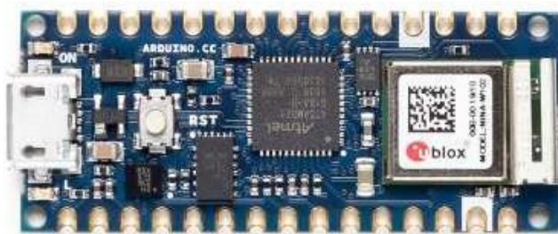
Рисунок 2.3 – Мікроконтролерний модуль Arduino Nano 33 IoT
