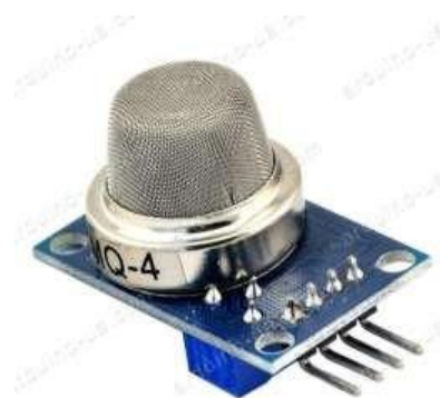
Рисунок 2.6 – Датчик метану MQ-4
