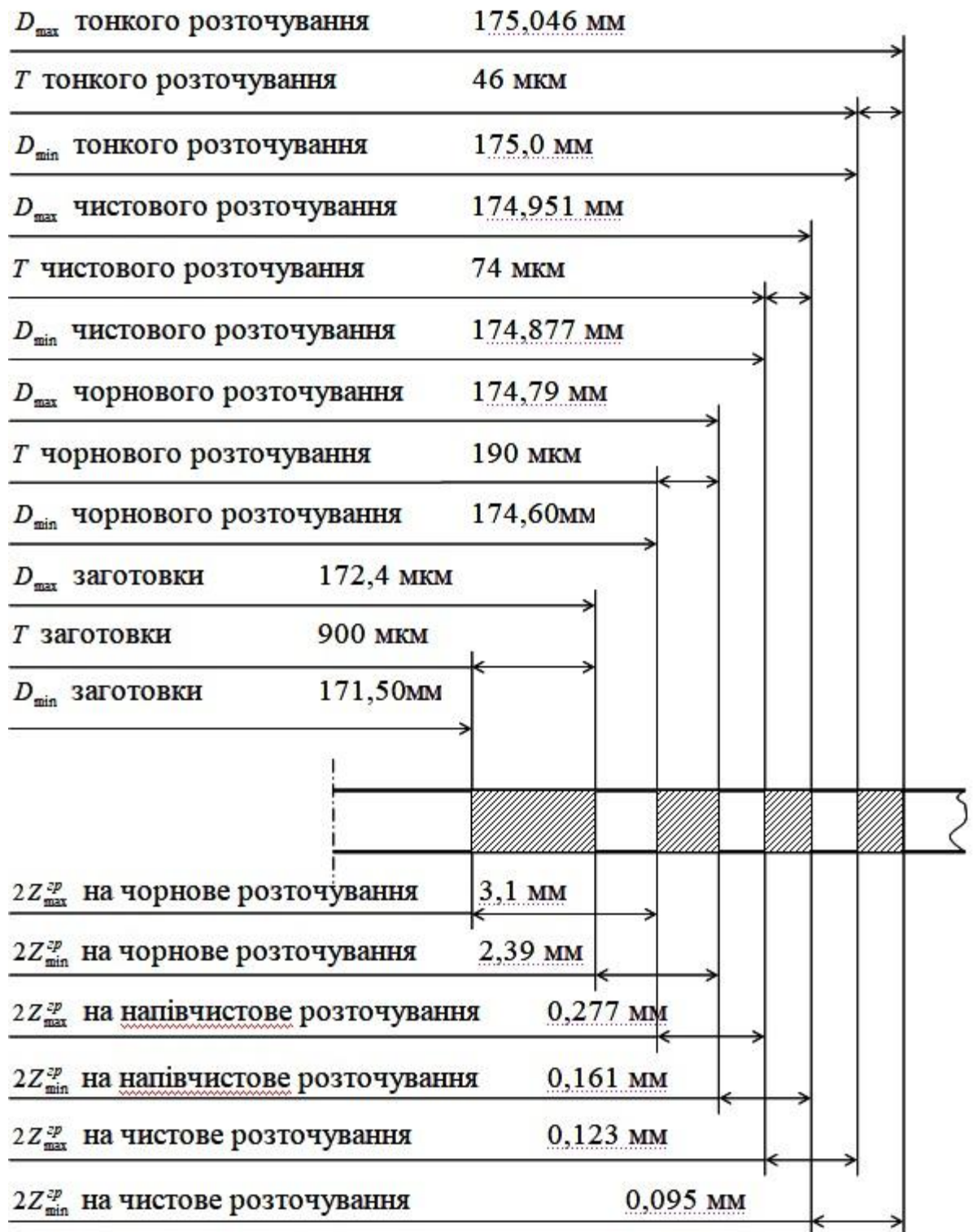
Рисунок 1.4 – Схема графічного розміщення припусків та допусків на обробку поверхні \text{Ø}175\text{H}7 (+0,046) мм.
