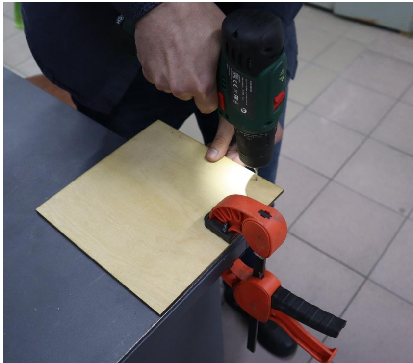
Рисунок 2.3.7 – Процес свердління отворів
