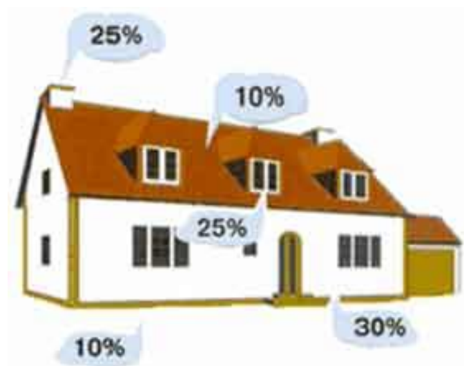
Рисунок 3.3 – Тепловтрати через теплозахисні конструктивні елементи будівлі.
