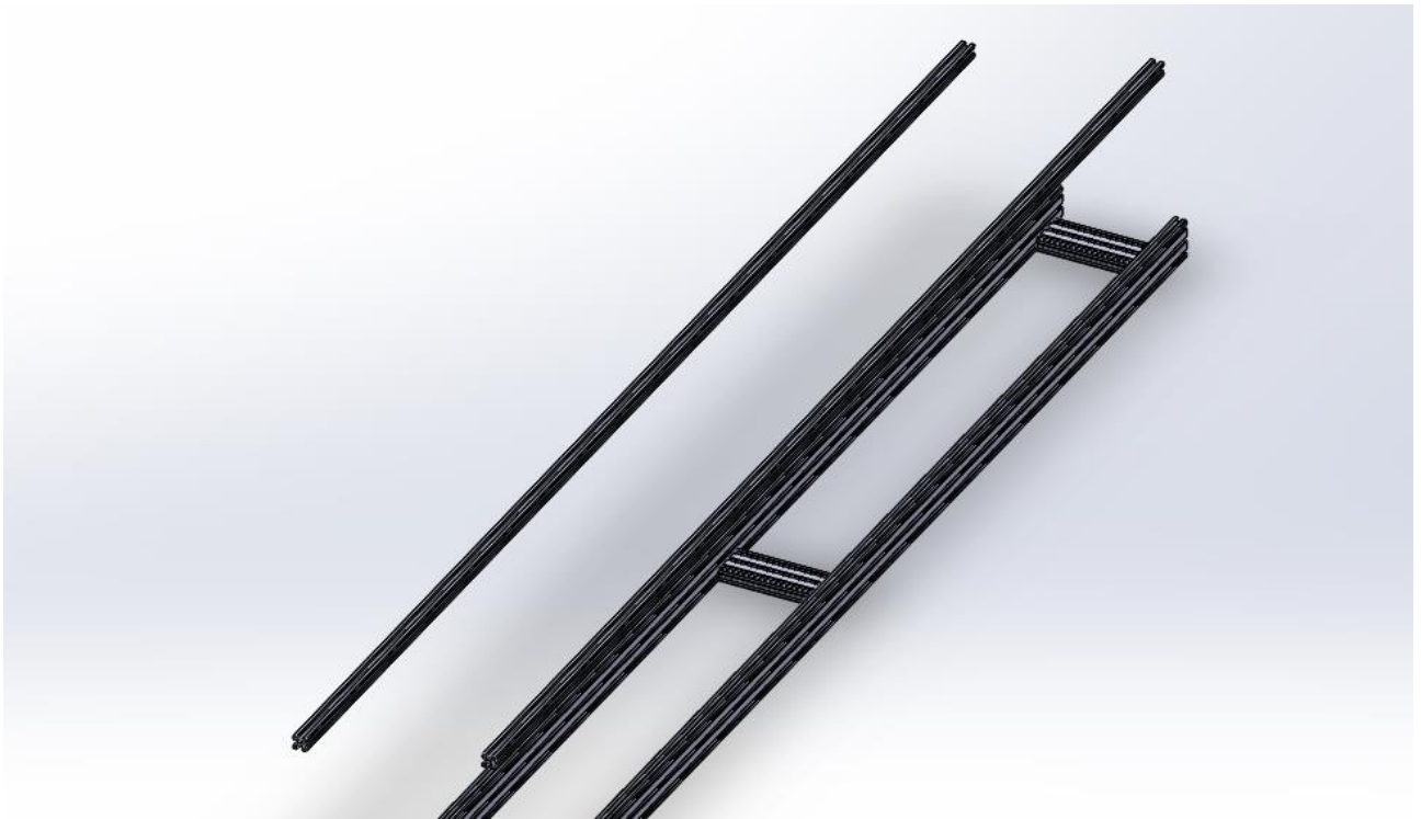
Рис 2.55. Додавання до збірки двох профілів 20x20-V
