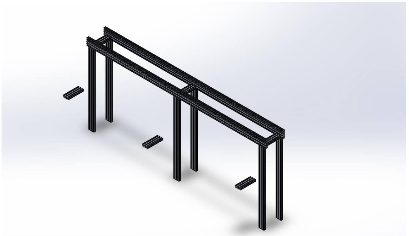
Рис 2.58. Додавання розпорок між ніжками стола Наступним кроком поперечени прив'язую до ножек стола.
