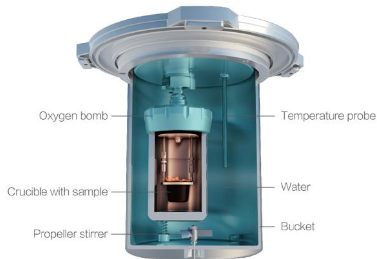
Рис. 2.4 – Поперечний переріз калориметра SDAC6000*
