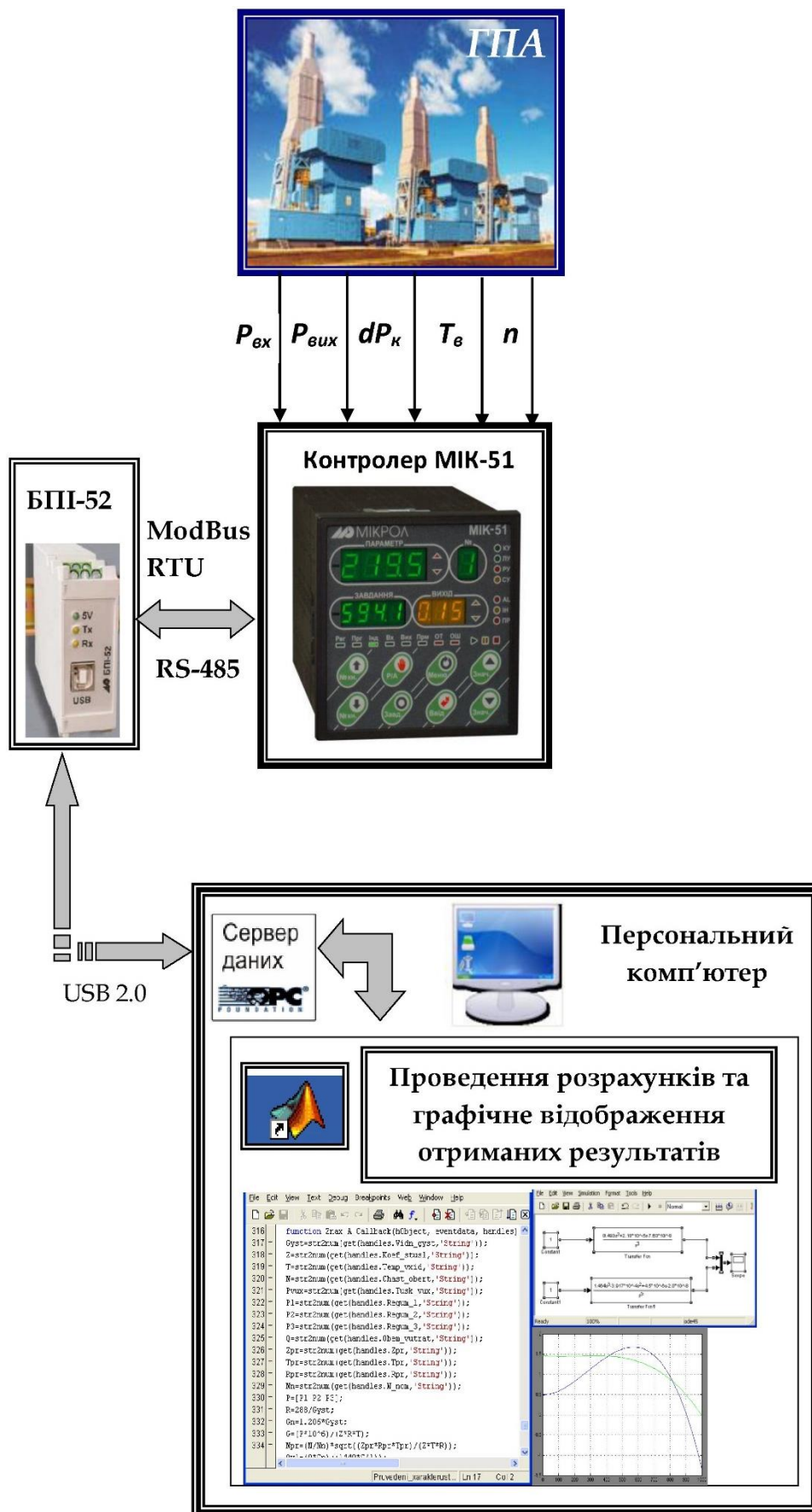
Рис. 3.2. Блокова схема розробленої системи
