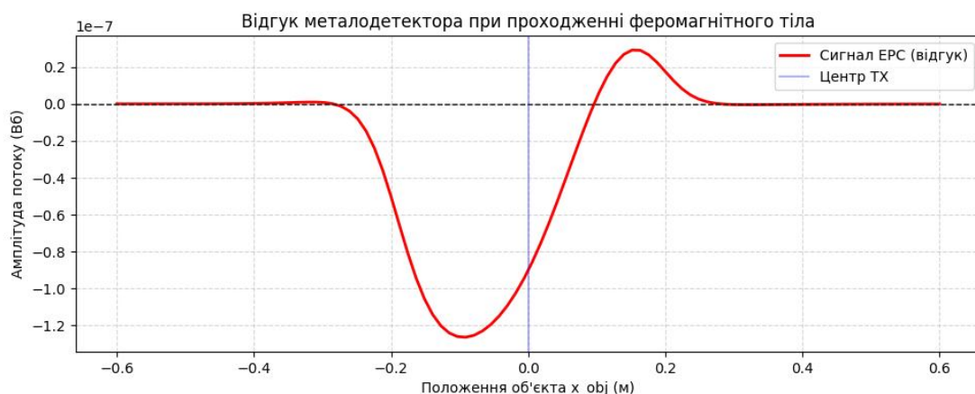
Рисунок 2.6– Вид залежності ЕРС на приймальні йкотушці при просуванні феромагнітного тіла повз котушки
