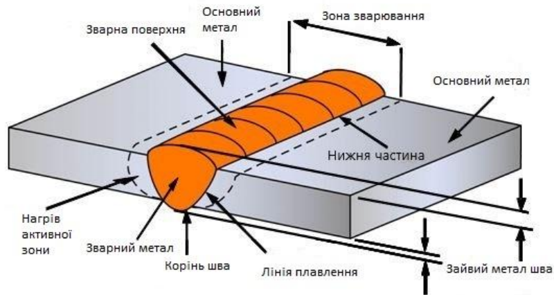
Рисунок 3.5.Схема дугове зварювання
