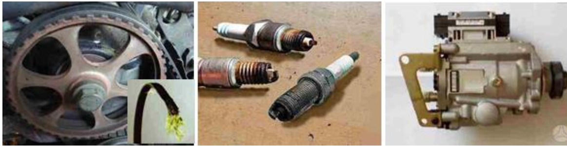
Рисунок 5 - Найбільш зношені деталі двигунів легкових автомобілів: а – ремень ГРМ, обрив ременя; б – свічки запалювання; в – паливний насос
