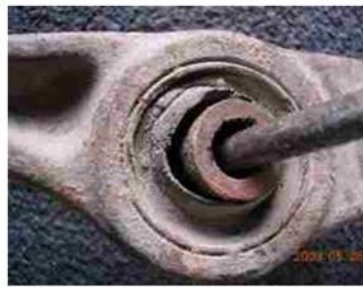
Рисунок 6 - Несправність сальника моста
