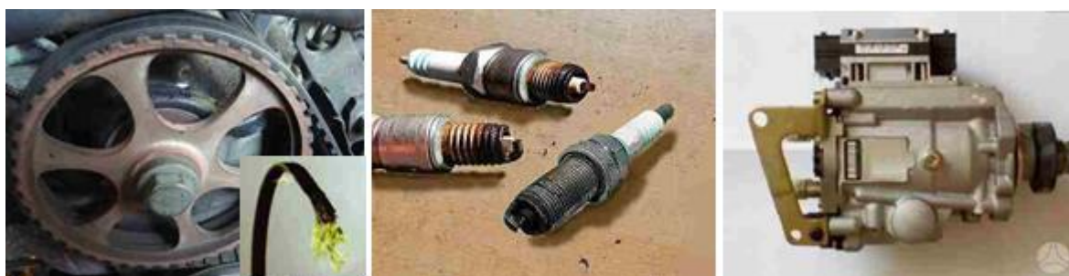
Рисунок 1.9 - Найбільш зношені деталі двигунів легкових автомобілів: а – ремень ГРМ, обрив ремня; б – паливні свічки запалювання; в – паливний насос
