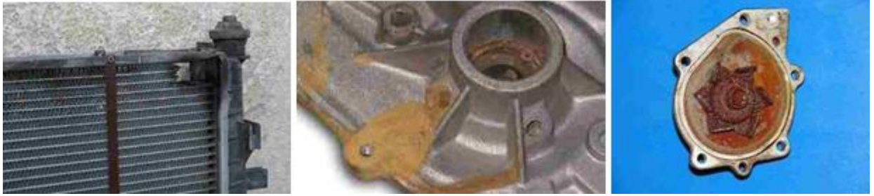
Рисунок 1.13 - Несправності основних частин системи охолодження: а – пошкодження радіатора; б – корозія, спричинена витоком охолоджувальної рідини; в – корозія насоса охолодження
