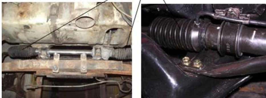
Рисунок 1.14 - Профілактичний захист рульових тяг від механічних пошкоджень
