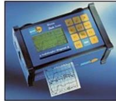
Рисунок 13 - Обладнання для випробування амортизаторів: а – осцилограф збору даних; б – підключення осцилографа до автомобіля
