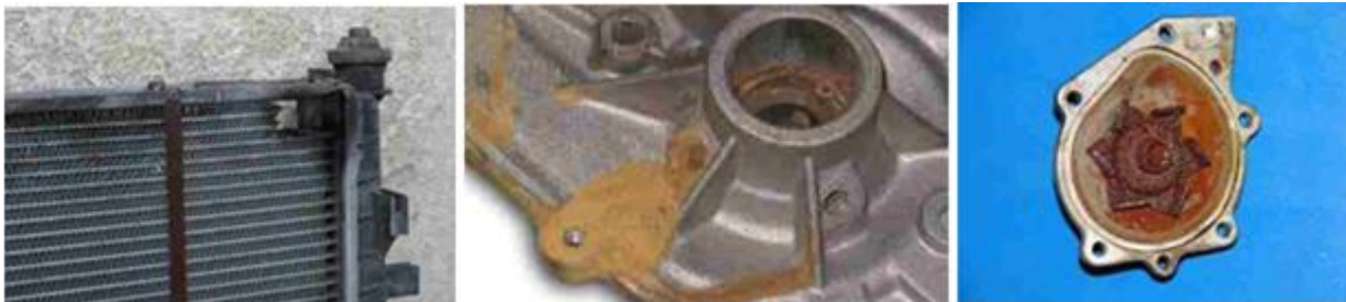
Рисунок 9 - Несправності основних частин системи охолодження: а – пошкодження радіатора; б – корозія, спричинена витоком охолоджувальної рідини; в – корозія насоса охолодження
