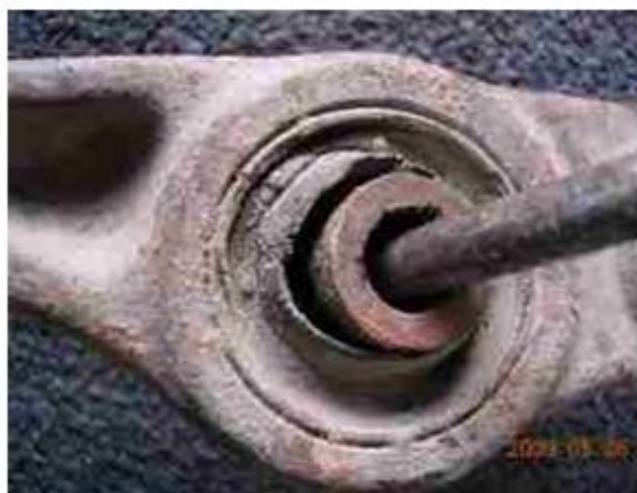
Рисунок 1.10 - Поломка сальника моста
