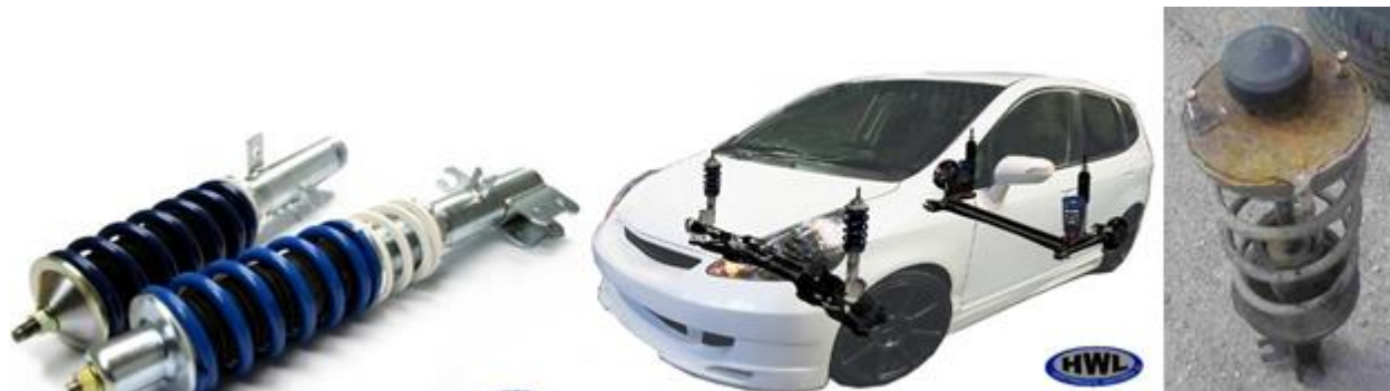
Рисунок 1.12 - Автомобільні амортизатори: а – амортизатори; б – встановлення амортизатора; с – поломки амортизатора
