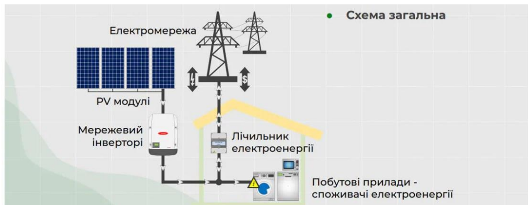
Рисунок 1.1 – Схема мережевої сонячної електростанції під власне споживання
