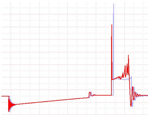
Рисунок 3.8 – Осцилограма за зменшеного зазору і навантаження на двигун (несправність).
