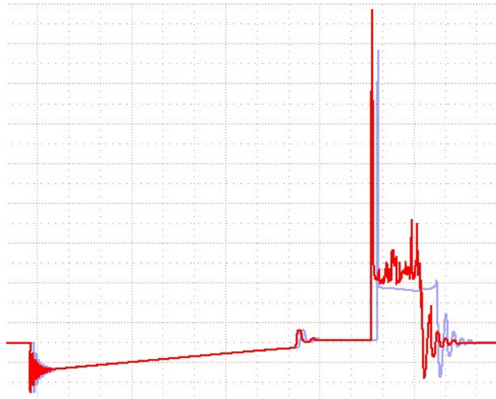
Рисунок 3.13 – Форма осцилограми, за забруднення свічкових електродів
