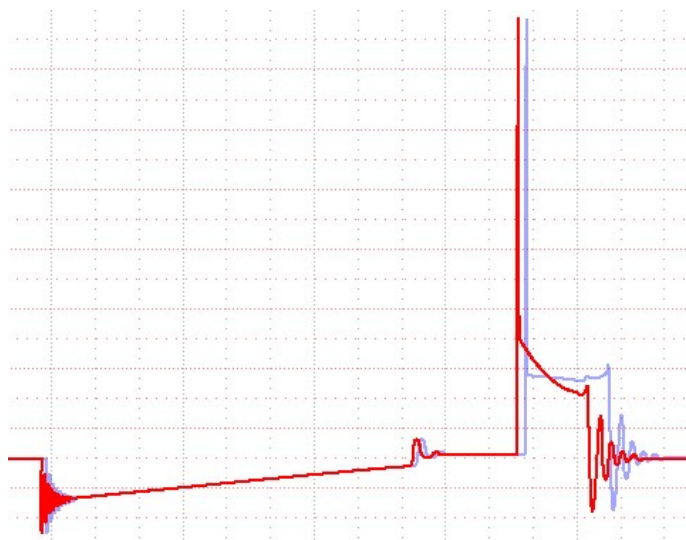
Рисунок 3.10 – Форма осцилограми, за збільшеного опору високовольтного провідника газового двигуна.
