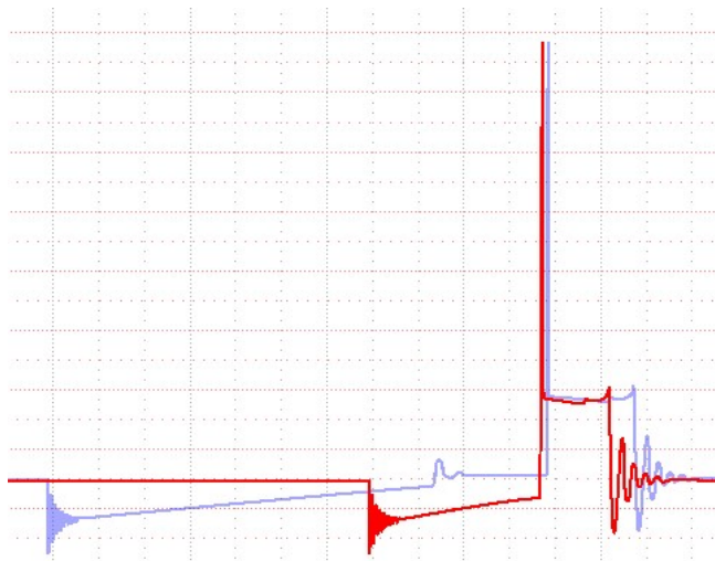
Рисунок 3.3 – Значний недозаряд котушки запалювання.
