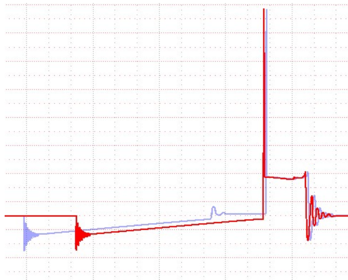
Рисунок 3.2 – Незначний недозаряд котушки запалювання
