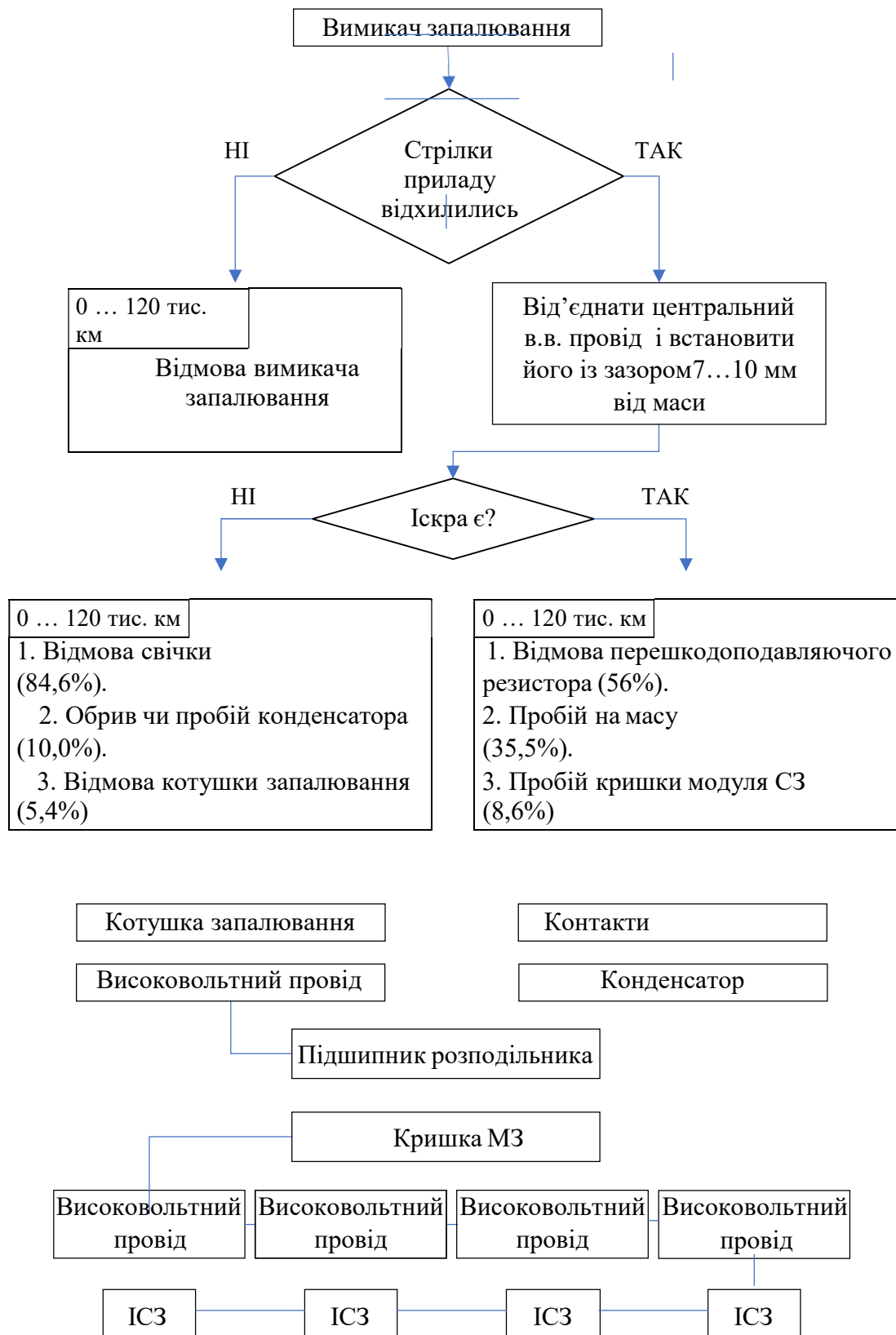
Рис. 4.1. Структурна схема моделі надійності СЗ для відмови типу "двигун запускається із труднощами"
