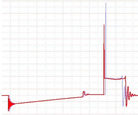
Рисунок 3.7 – Осцилограма за зниженої компресії.
