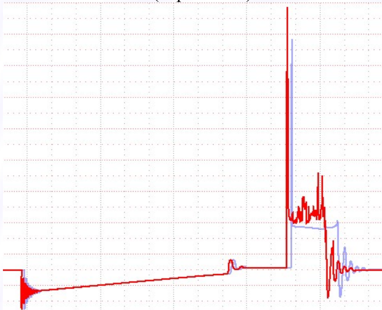
Рисунок 2 – Форма осцилограми, за забруднення свічкових електродів
