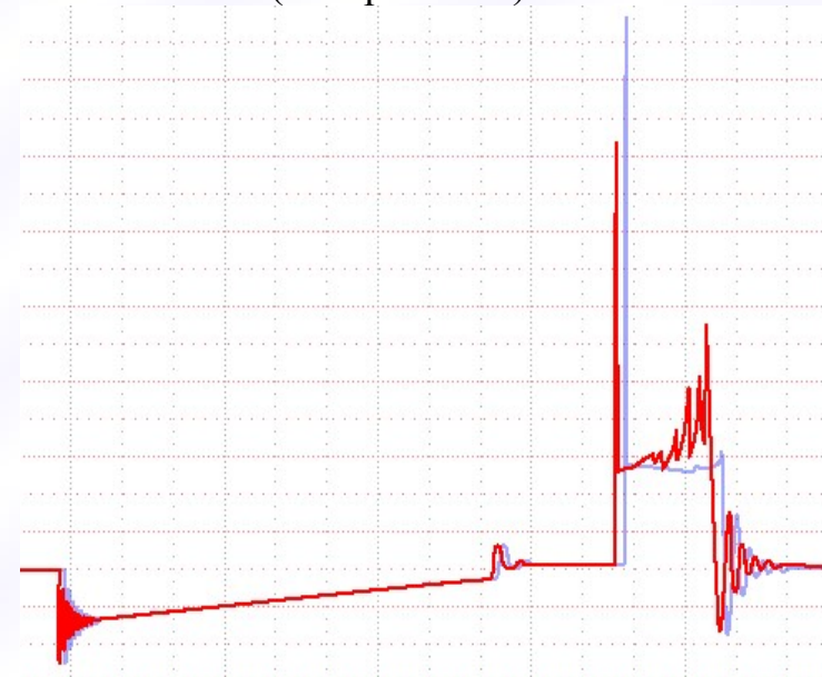
Рисунок 4 – Осцилограма за зменшеного зазору електродів свічок (несправність).
