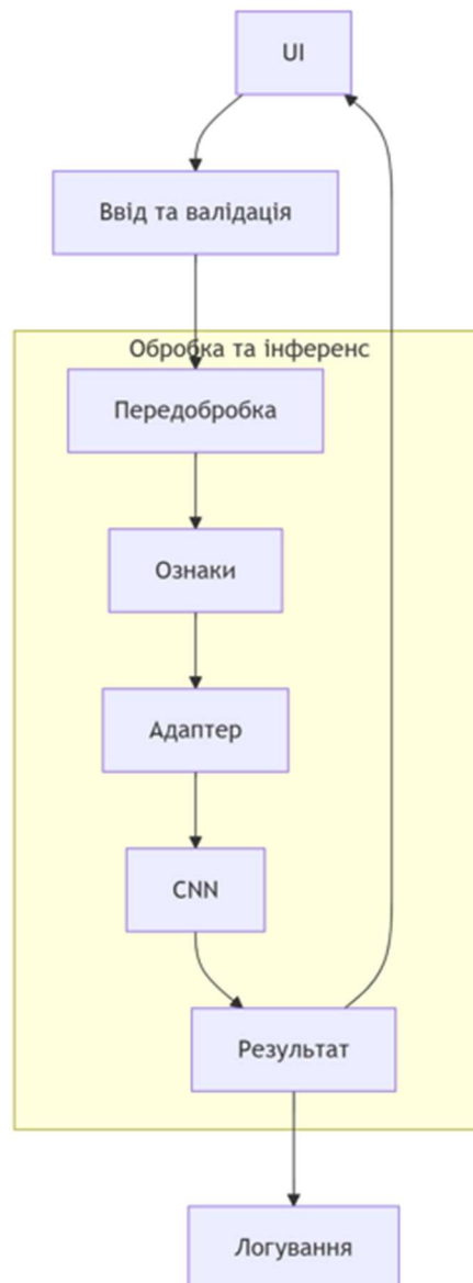
Рисунок 2.5 – Компонентна схема програмної системи класифікації аудіоданих
