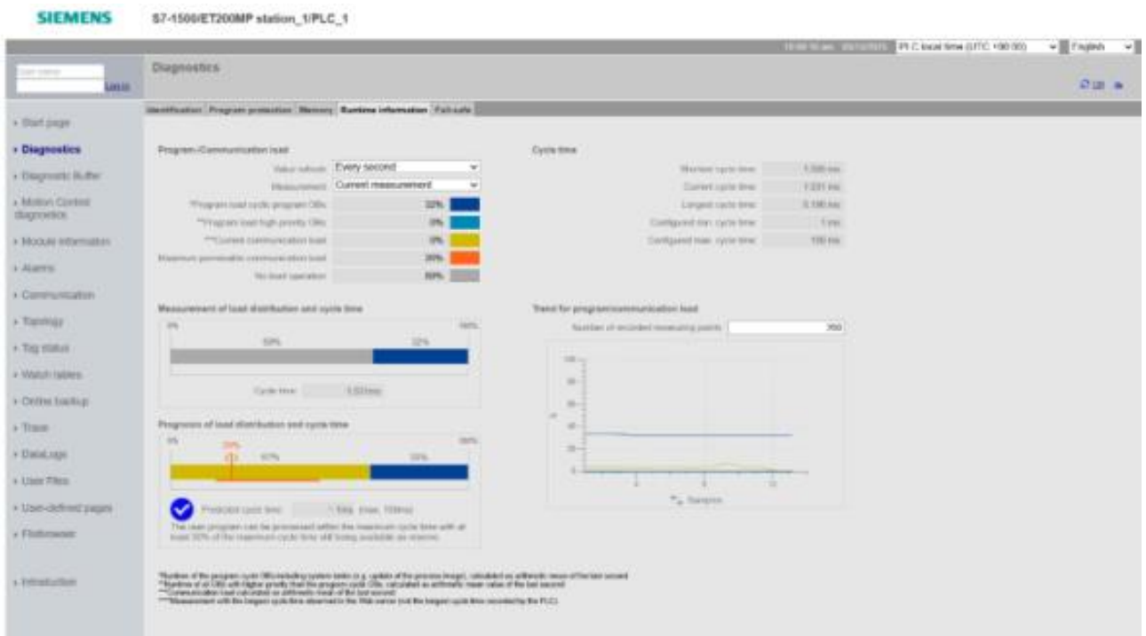
Рисунок 4.19 - Тестування стандартної (діагностичної) сторінки WEB-сервера PLC Simatic S7-1500, розділ «Diagnostics» → «Runtime information»
