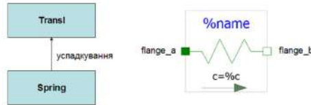
Створення компонента "пружина" мовою Modelica шляхом успадкування базового класу Transl
