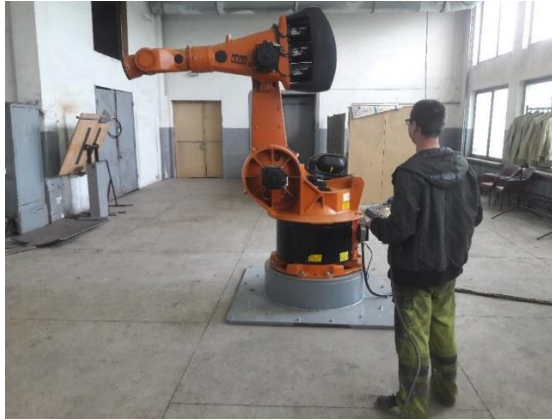
Рисунок 2.1 – Робот KUKA KR200 в навчально науковому центрі професійної підготовки і практики ІФНТУНГ
