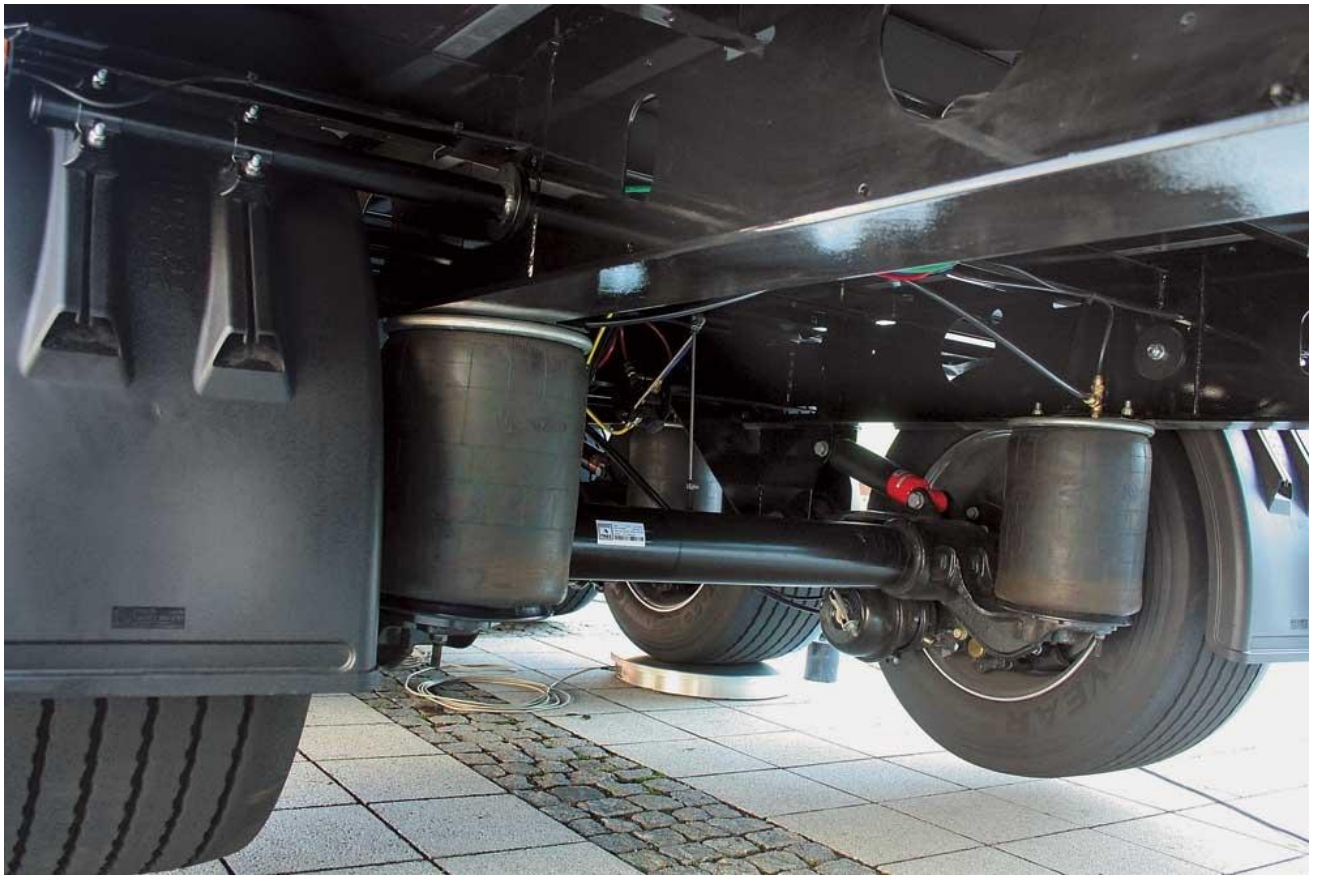
Рисунок 1.3. Пневматична підвіска вантажних автомобілів та причепів
