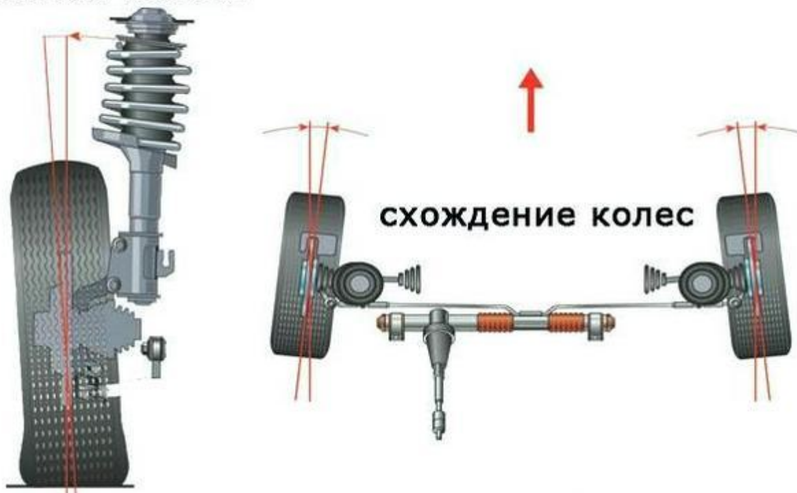
Рисунок 1.1. Схема налаштування розвал-сходження автомобіля
