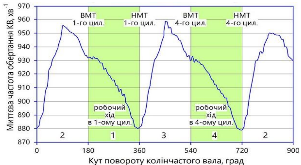
Рис. 3.4. Графік зміни сигналу датчику-витратоміру повітря 4-циліндрового рядного двигуна з робочим об'ємом 2,0 л автомобіля BMW X5 f15 20D при справному клапані рециркуляції
