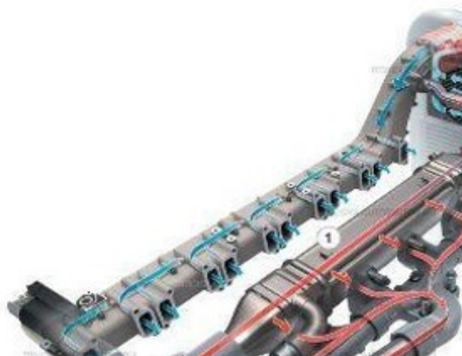
Рисунок 6.3 - Двоступінчате охолодження рециркулюючих газів в системі рециркуляції відпрацьованих газів дизелів «Рено»: 1 - рідинний охолоджувач, 2 - повітряний охолоджувач
