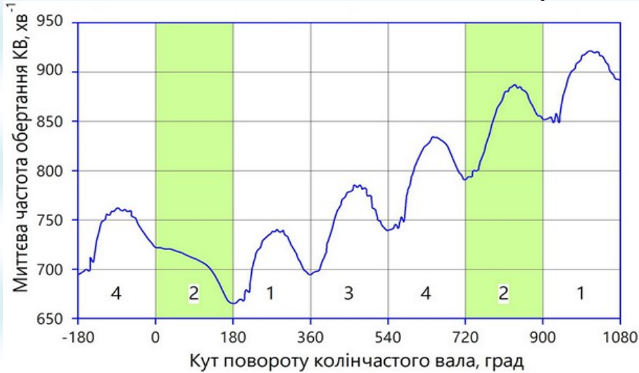
Рис. 11.1. Графік зміни миттєвої частоти обертання КВ двигуна Опель Z22SE з несправністю паливної форсунки 2-го циліндра на режимі вільного прискорення
