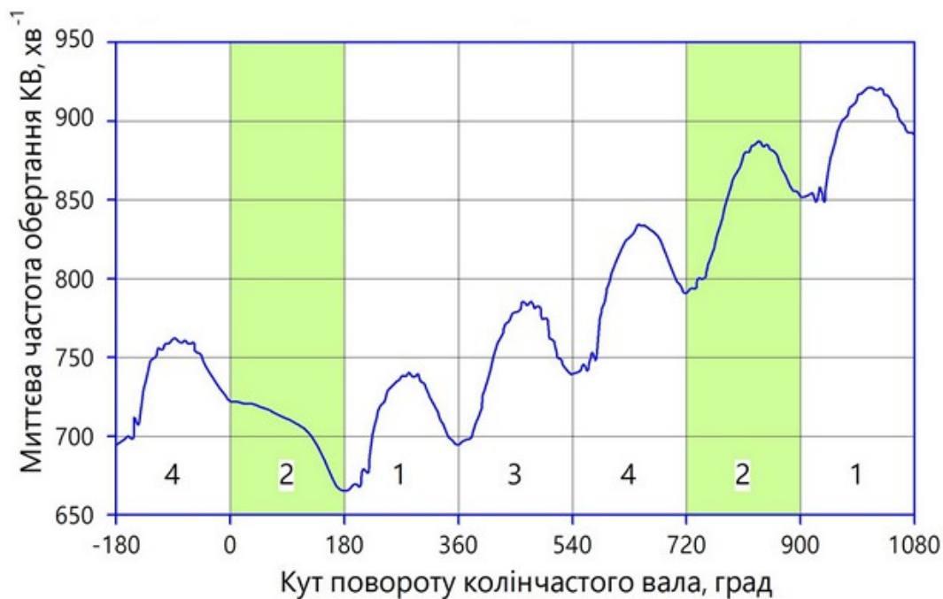
Рис. 3.5. Графік зміни миттєвої частоти обертання КВ двигуна Опель Z22SE з несправністю паливної форсунки 2-го циліндра на режимі вільного прискорення
