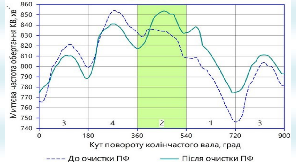
Рис. 11.3. Графік зміни миттєвої частоти обертання КВ двигуна Опель Z22SE до та після ультразвукової очистки форсунок з відключеним 1-им циліндром
