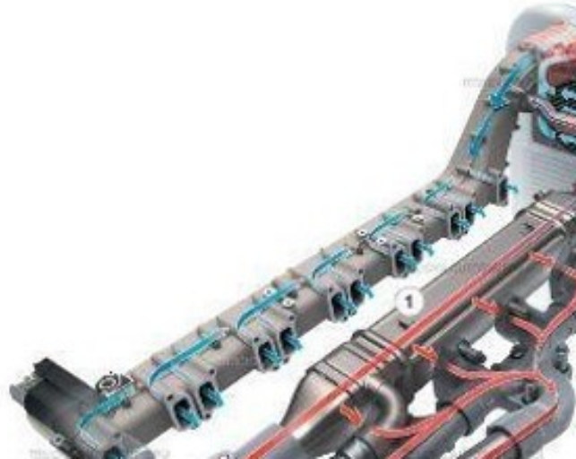
Рисунок 1.9 - Двоступінчате охолодження рециркулюючих газів в системі рециркуляції відпрацьованих газів дизелів «Рено»: 1 - рідинний охолоджувач, 2 - повітряний охолоджувач
