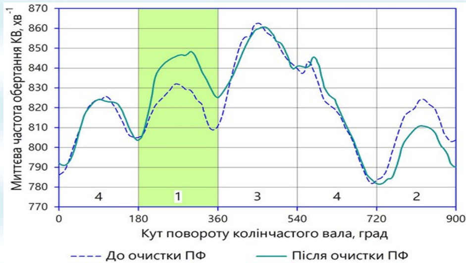
Рис. 12.1. Графік зміни миттєвої частоти обертання КВ двигуна K4J740 автомобіля Renault Megane II до та після ультразвукової очистки форсунок з відключеним 1-ім циліндром
