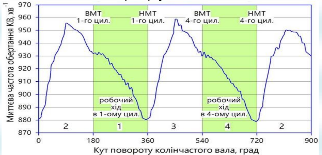
Рис. 10.4. Графік зміни сигналу витратоміру повітря двигуна BMW X5 f15 20D при справному клапані рециркуляції
