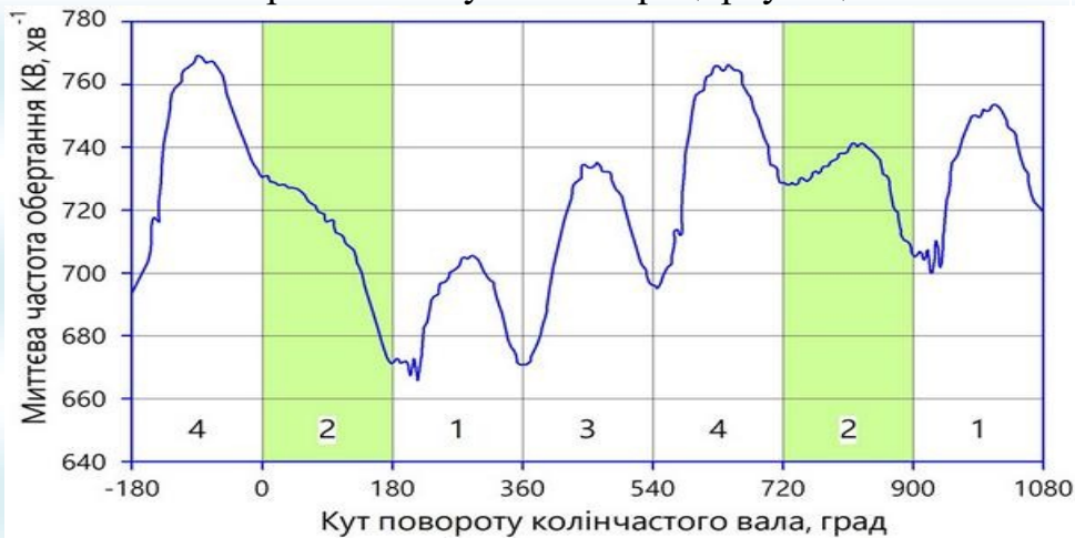
Рис. 10.3. Графік зміни сигналу витратоміру повітря двигуна BMW X5 f15 20D при негерметичному клапані рециркуляції
