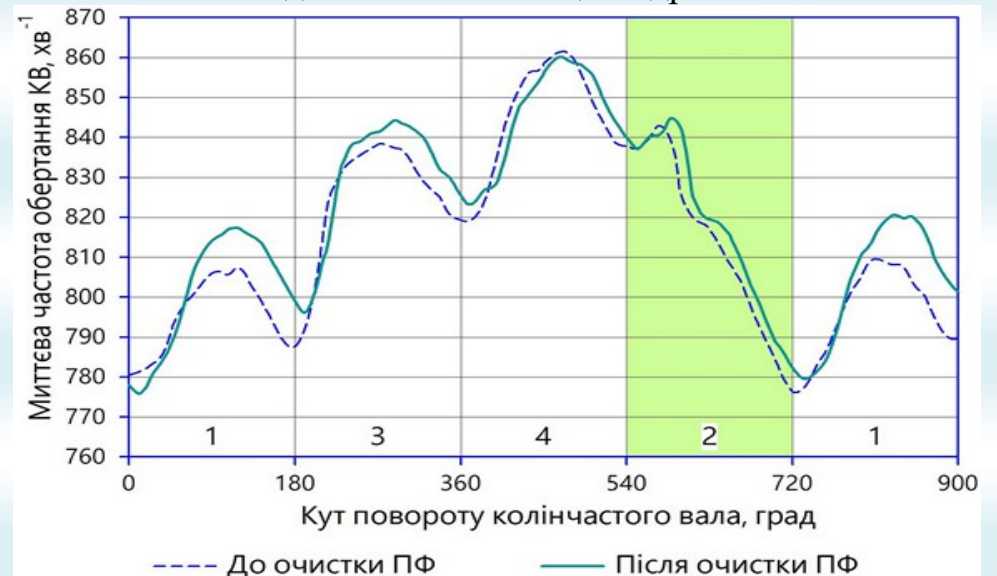
Рис. 11.4. Графік зміни миттєвої частоти обертання КВ двигуна Z22SE до та після ультразвукової очистки форсунок з відключеним 2-им циліндром
