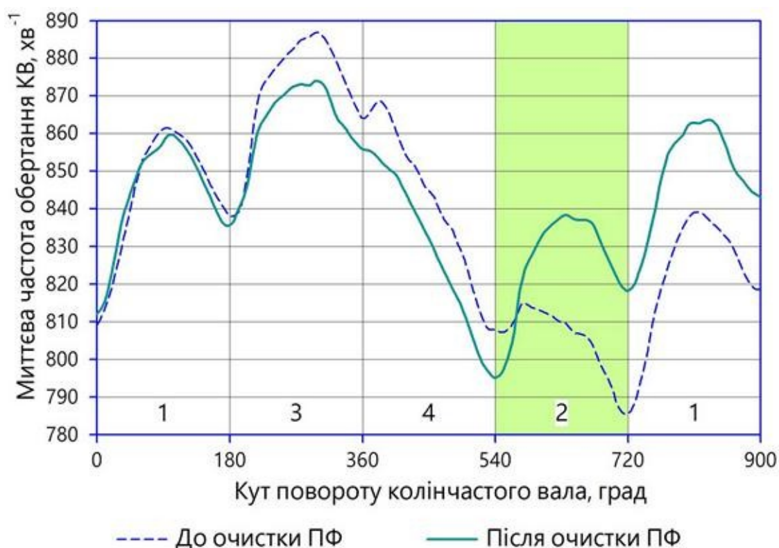
Рис. 3.10 Графік зміни миттєвої частоти обертання КВ двигуна Z22SE до та після ультразвукової очистки форсунок з відключеним 2-им циліндром
