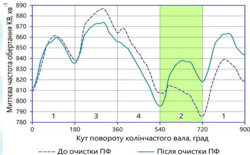
Рис. 12.2 Графік зміни миттєвої частоти обертання КВ двигуна K4J740 автомобіля Renault Megane II до та після ультразвукової очистки форсунок з відключеним 2-им циліндром
