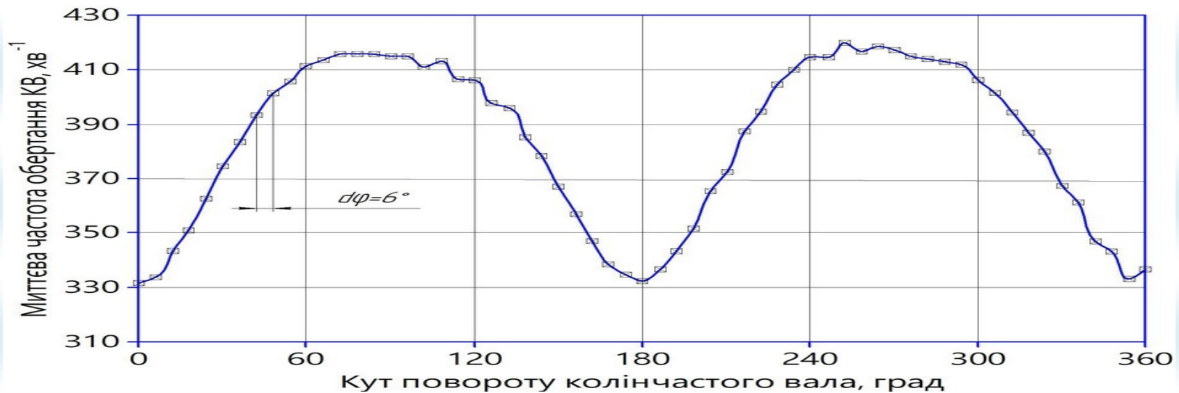
Рис. 8.2. Приклад графіка зміни миттєвої частоти обертання колінчастого вала через проміжки в 6^\circ ПКВ
