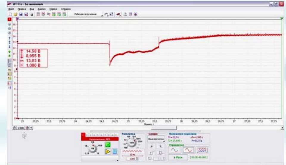
Рис. 9.3. Запис осцилограмми напруги клапану EGR за допомогою мотор-тестера (пуск двигуна і робота на XX)
