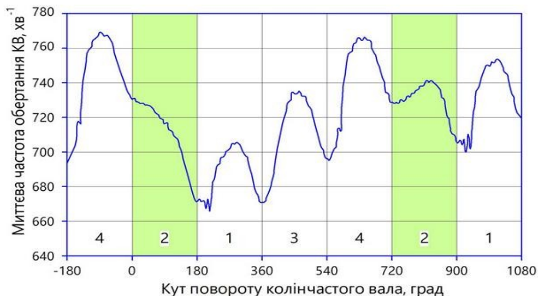
Рис. 3.3. Графік зміни сигналу датчику-витратоміру повітря 4-циліндрового рядного двигуна з робочим об'ємом 2,0 л автомобіля BMW X5 f15 20D при негерметичному клапані рециркуляції
