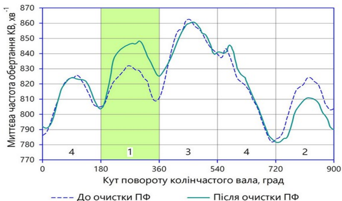
Рис. 3.7. Графік зміни миттєвої частоти обертання КВ двигуна K4J740 автомобіля Renault Megane II до та після ультразвукової очистки форсунок з відключенням 1-ім циліндром
