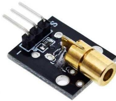
Рисунок 2.3 – Лазерний модуль KY-008
