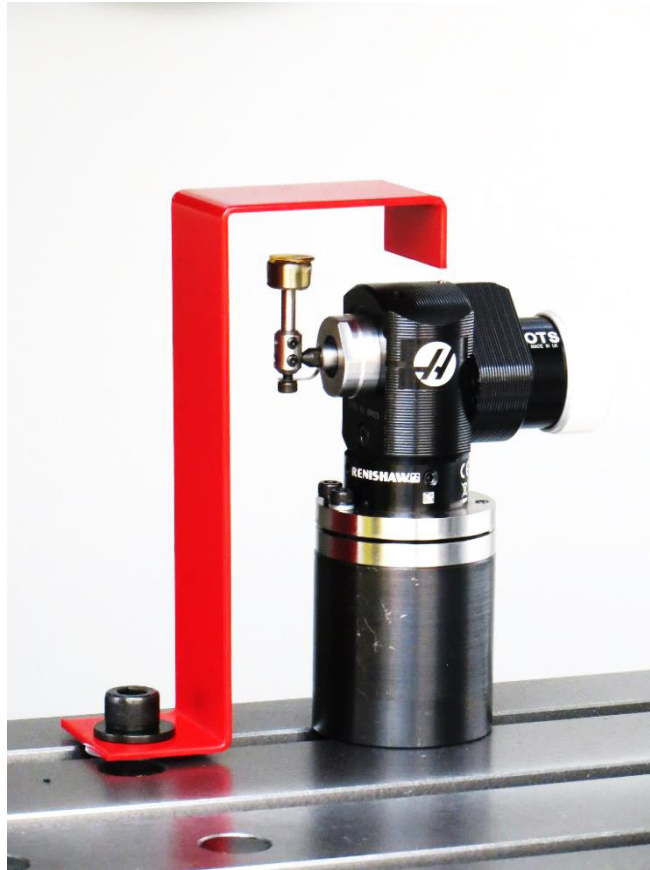
Рисунок 2.7.1- Зображення датчика для налагодження інструменту.
