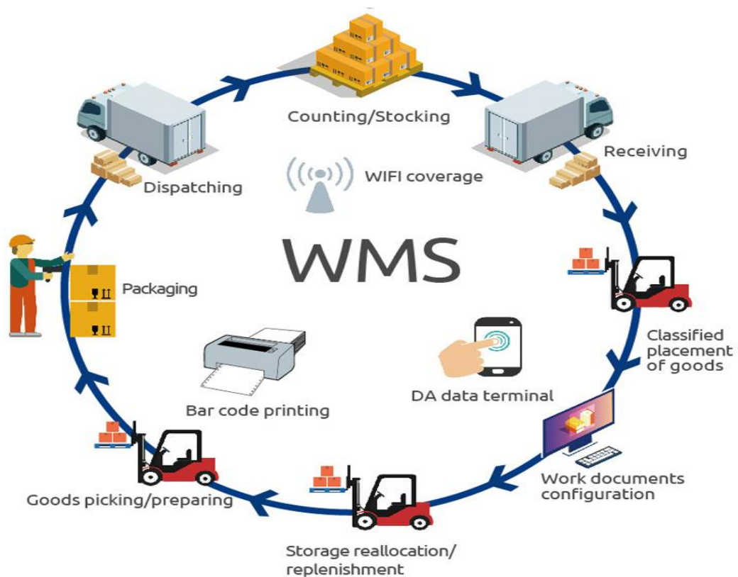
Рисунок 3.1- Схема роботи автоматизованої системи управління складом
