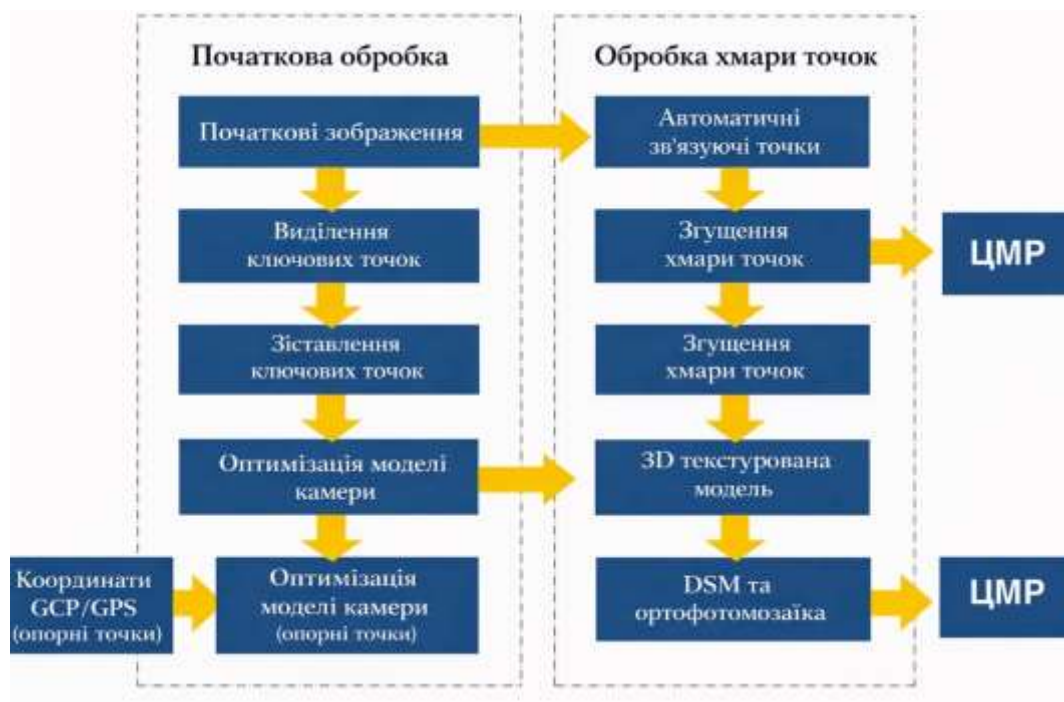
Рисунок 4 Схема обробки даних БПЛА для створення 3D-моделі
