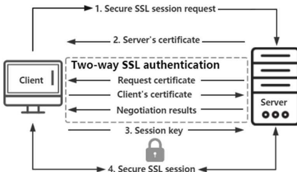
Рис. 1.8. Процес автентифікації зв'язку SSL.
