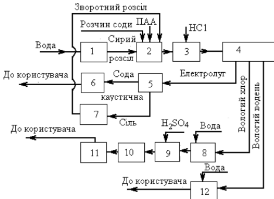
Рисунок 1.2 – Принципова технологічна схема виробництва гідроксиду натрію, хлору й водню: 1 – розчинення солі привізний або підземної; 2 – содово-каустичне очищення розсолу 3 – нейтралізація розсолу; 4 – електроліз; 5 – упарювання електролугів; 6 – баки-збірники; 7 – готування зворотного розсолу; 8 – охолодження хлору; 9 – осушення хлору; 10 – скраплення хлору; 11 – танки рідкого хлору; 12 – охолодження водню
