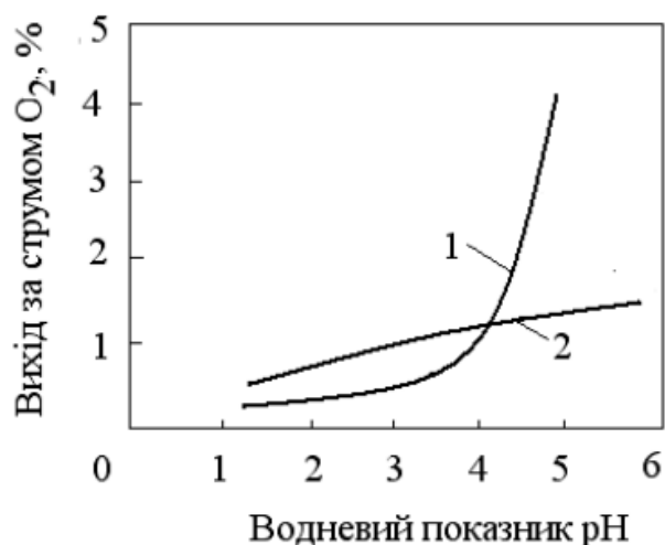
Рисунок 2.5 – Вихід за струмом кисню в залежності від рН розчину NaCl при щільності струму 2 кА/м 2 і температурі 80 °С: 1 – ОРТА; 2 – платинований титан
