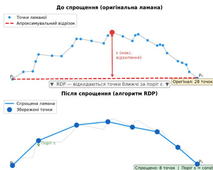
Рисунок 4.4 — Спрощення траєкторії алгоритмом Рамера–Дугласа–Пекера
