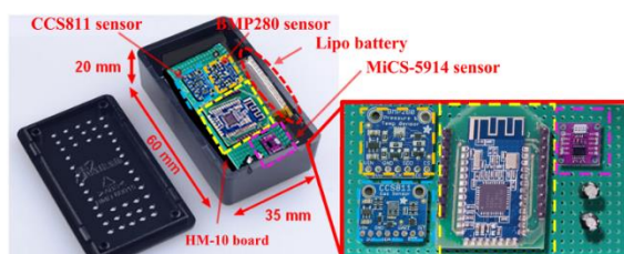
Рисунок 3.9 - Прототип розробленої смарт-мітки, розміщеної всередині пластикової коробки з перфорованою кришкою.
