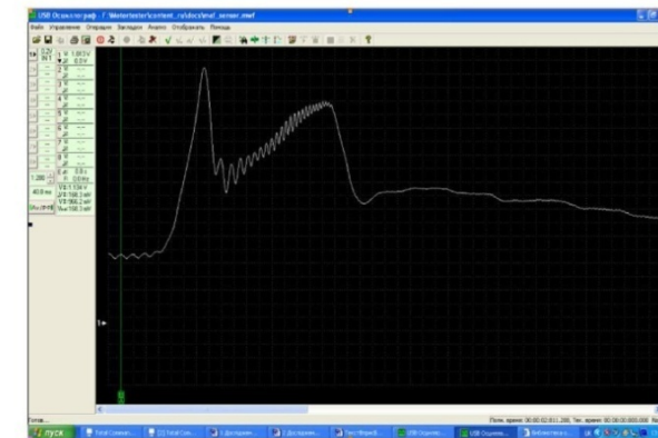
Рис. 5 - Осцилограма вихідного сигналу датчику тиску оливи гідронаосу підкачки автоматичної коробки перемикання передач
