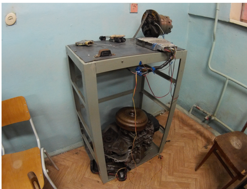
Рисунок 6.1 – Експериментальна установка для діагностики автоматичної коробки передач CD4E з електронним управлінням
