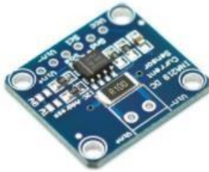
Рисунок 2.4 – Загальний вигляд цифрового датчика струму та напруги на INA219 з шиною I2C [11]
