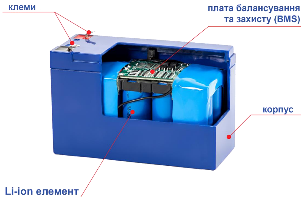
Рисунок 1.4 – Будова літій-іонного акумулятора [7]
