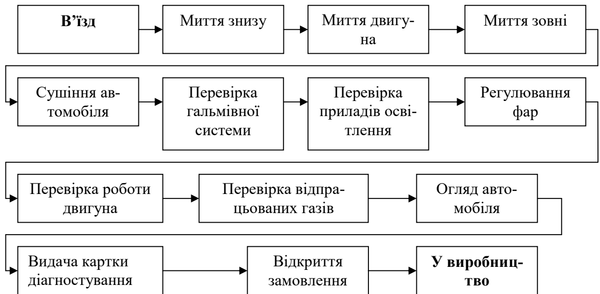
Рисунок 5.1 - Схема поточного технологічного процесу приймання автомобіля на ТО та ремонт СТО
