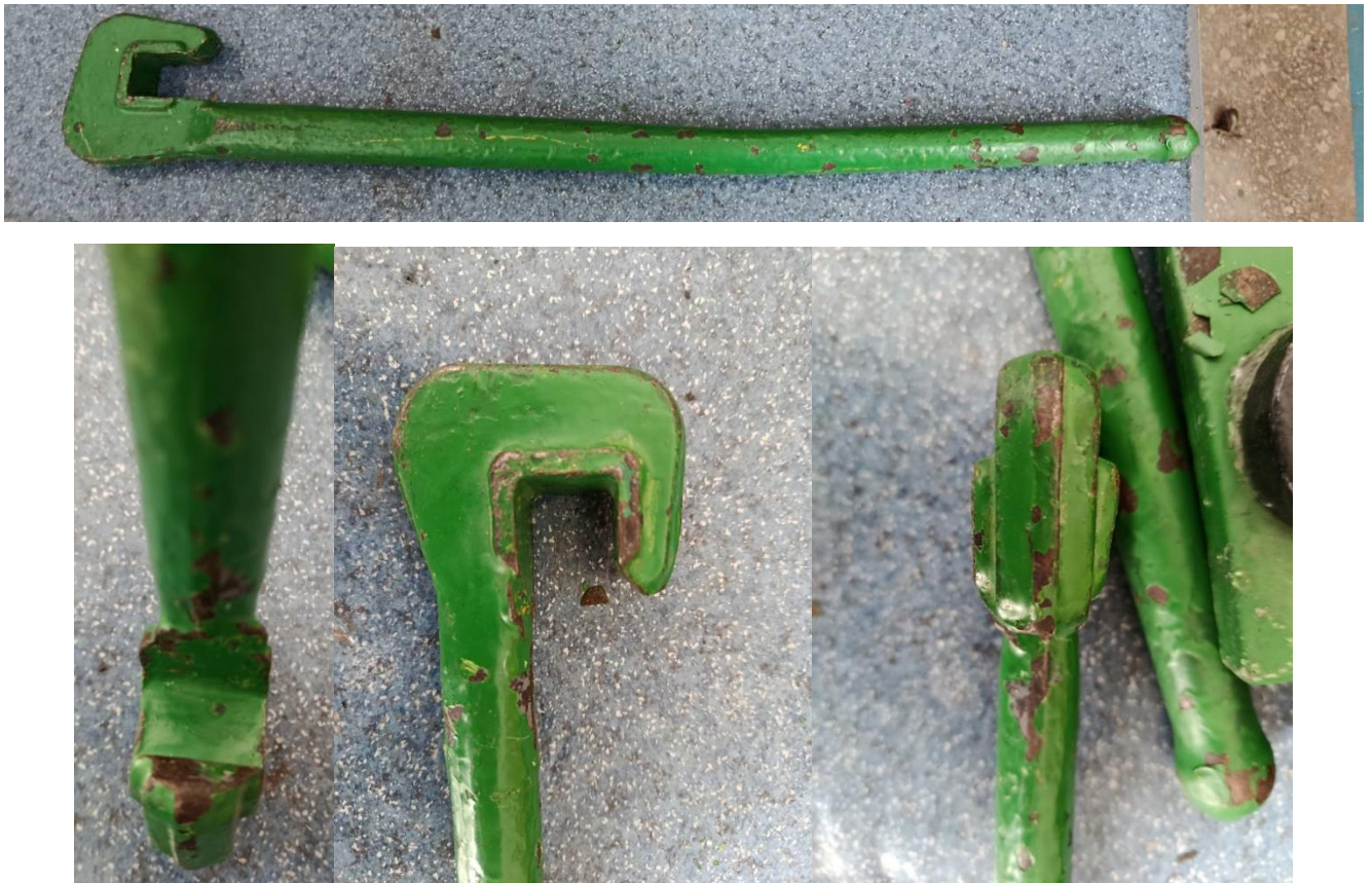
Рисунок 4.1 – Фотографії ключа для згвинчування-розгвинчування насосних шатнГ
