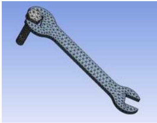
Рисунок 2.13 – Сітка скінченних елементів
