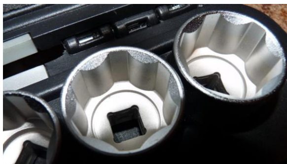
Рисунок 2.18 – Зовнішній вигляд головок Super Lock
