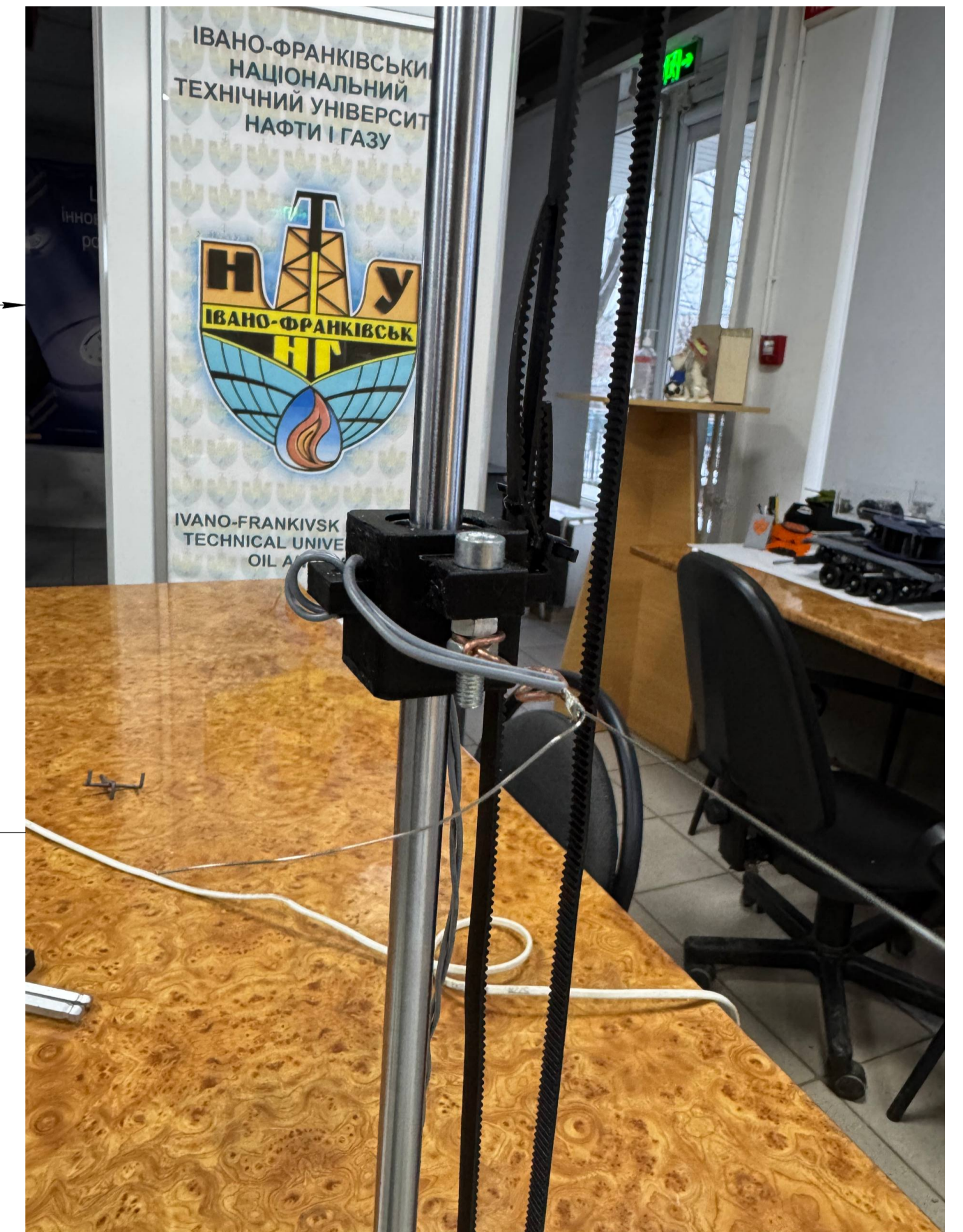
Монтаж кронштейну і фіксація струни на ньому
